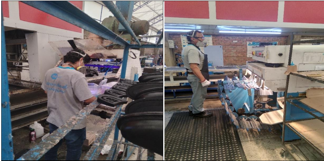
Fotografía 19. Aplicación de pegamento y reactivadora
