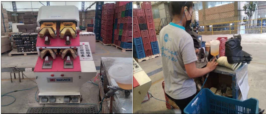
Fotografía 8. Conformadora de talones
