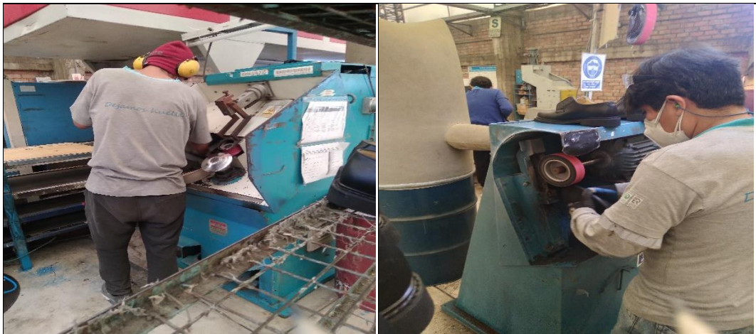
Fotografía 20. Eliminación de exceso de rebaba y pulido de calzado
