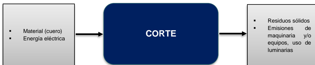
Figura 20. Diagrama de flujo para el subproceso de corte
