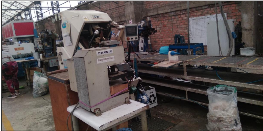
Fotografía 16. Armadora de punta
