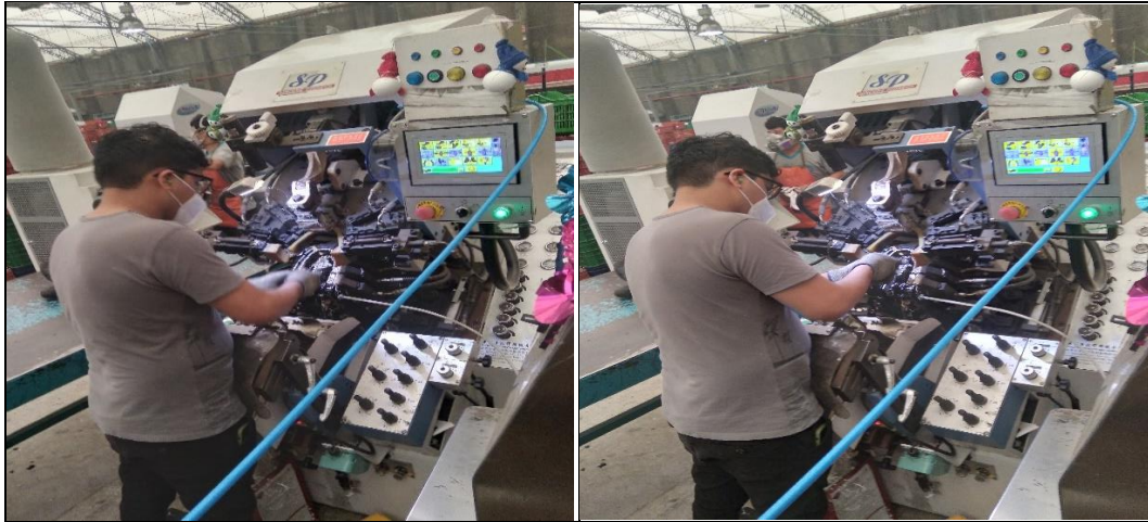
Fotografía 10. Armadora de punta
