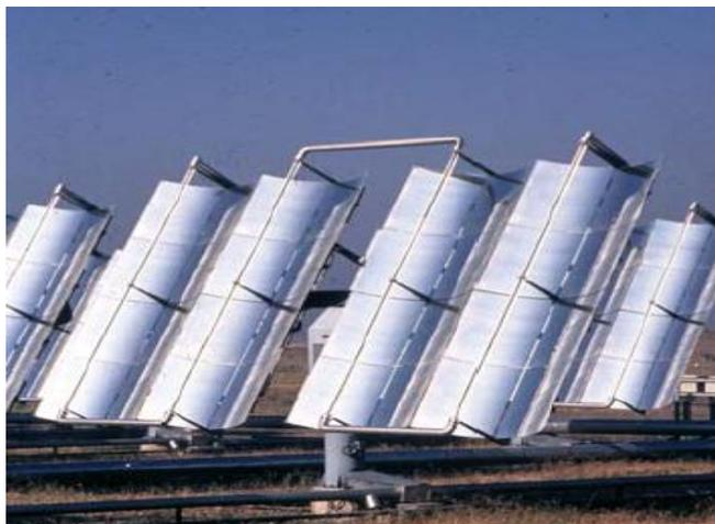
**Figura 5.11: Sistema de seguimiento de un eje**
