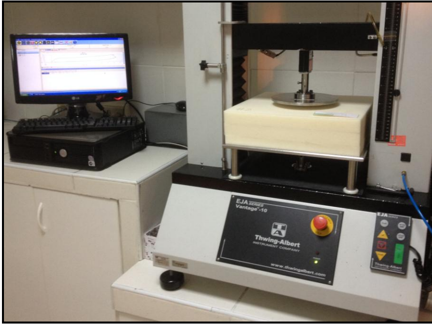
Figura 1. Sistema de armado para ensayo de tiempo de recuperación
