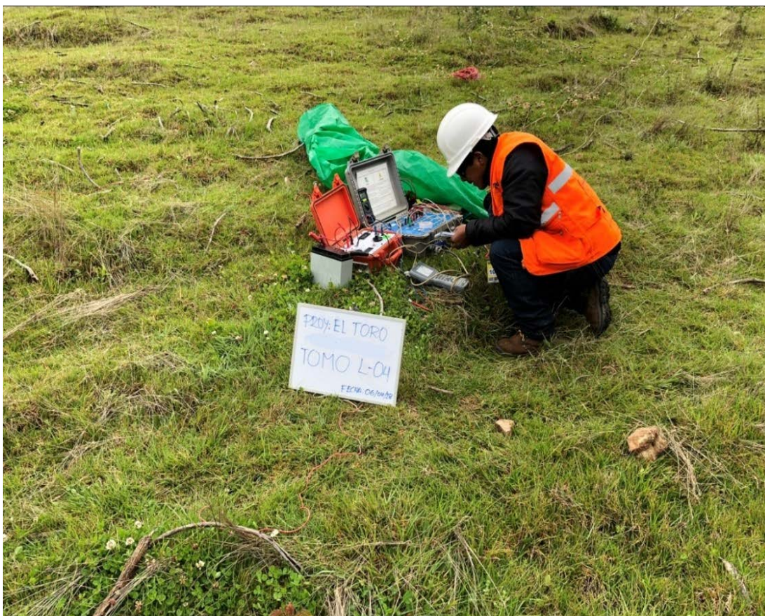
Figura 5.14 Equipamiento para tomografía eléctrica
