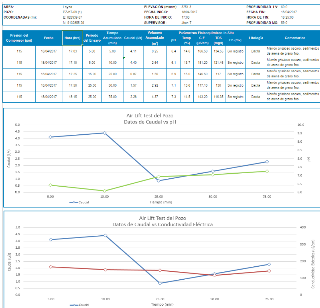
Figura 5.40 Prueba Air Lift (Sondaje PZ – HT – 09) a profundidad de 66.90 metros
