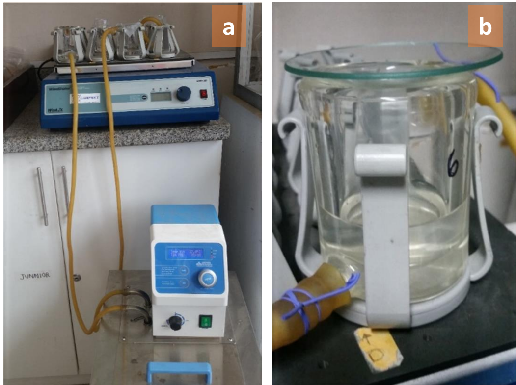
Figura 10. Sistema de liberación utilizado para la liberación de Clorhexidina a partir de películas de Quitosano. (a) Shaker y chiller para brindar las condiciones de liberación (b) Chaqueta de vidrio.
