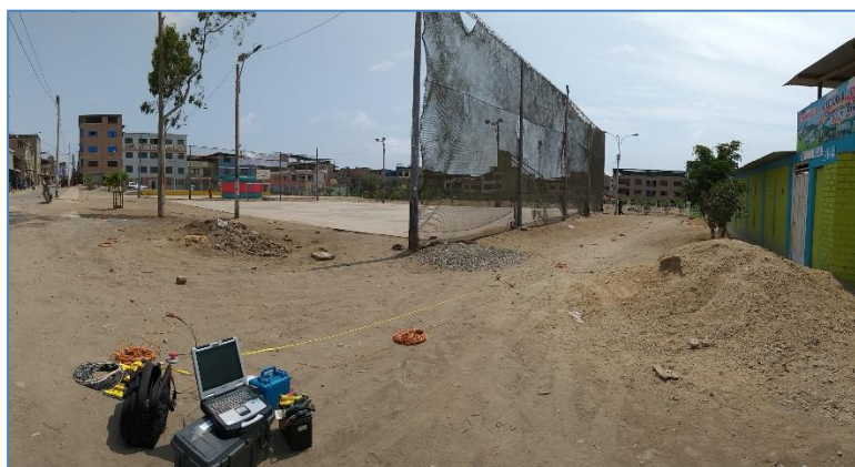
Figura 36. Equipo de medición de ensayo MASW y MAM.
