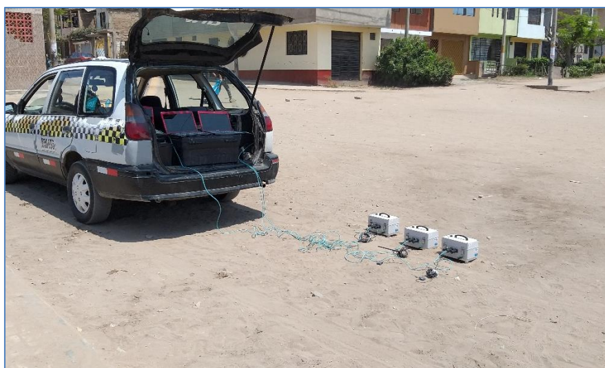
Figura 35. Equipo de medición de microtrepidaciones.
