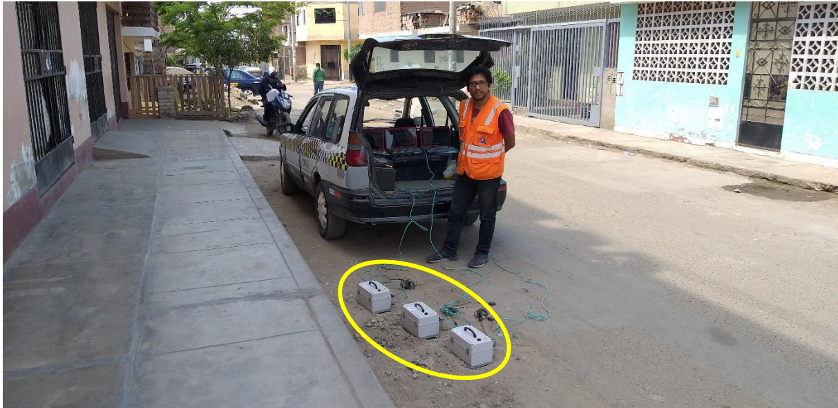
FOTO M-15: Se muestran los sensores en el momento del registro de la vibración ambiental. El ensayo se realizó cerca entre el Parque 23 y la Av. 1ro de Mayo.
