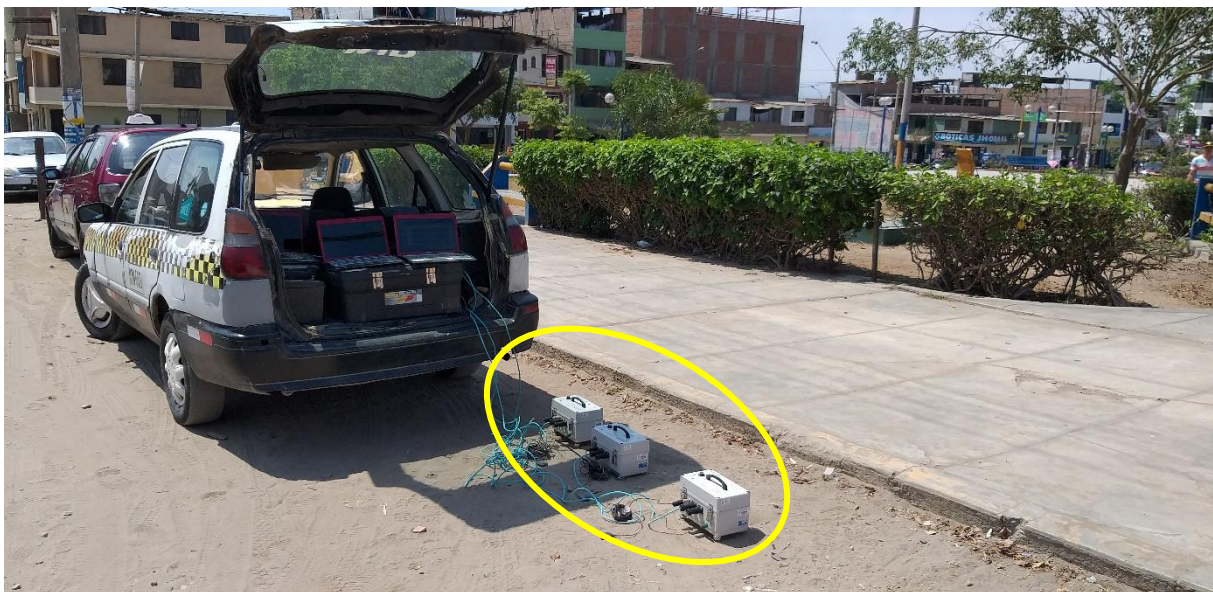
FOTO M-02: Se observa la disposición de los sensores para el ensayo de microtremores, realizado en el parque de La Paz.
