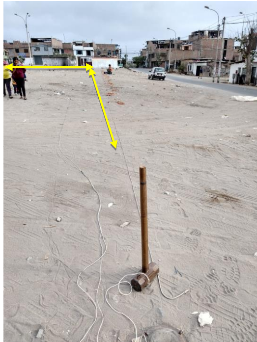
FOTO MASW-MAM 05: Se observa el tendido de cables con geófonos cerca a la Av. Huaylas.
