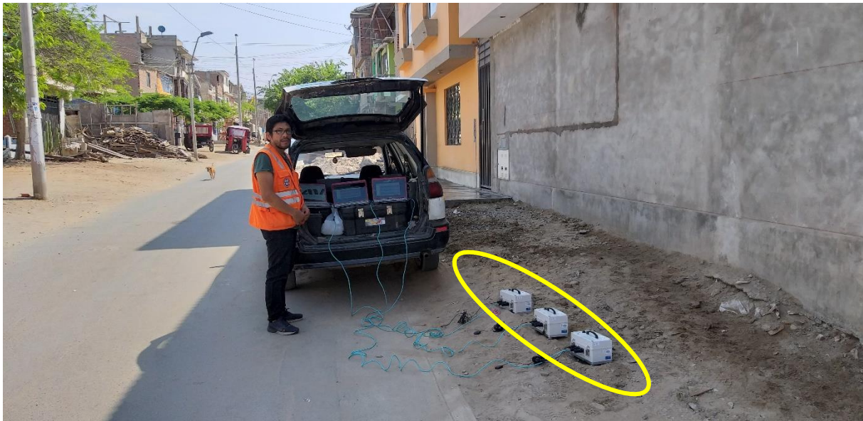
FOTO M-01: Se observa la disposición de los sensores para el ensayo de microtremores, en el sector 4 realizado a una cuadra de la Av. Revolución con Guardia Republicana.
