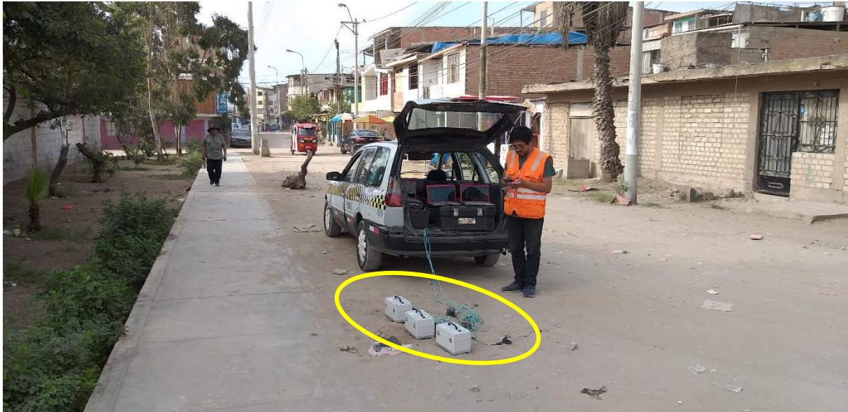
FOTO M-13: Se muestra la disposición de los sensores para la medición de microtemores realizado frente al parque del sector 2 grupo 14.
