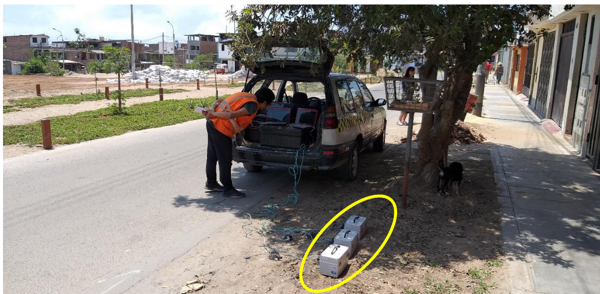
FOTO M-04: Se muestran los sensores del equipo de microtemores ubicados en el jardín frente al parque Pachacamac I etapa.
