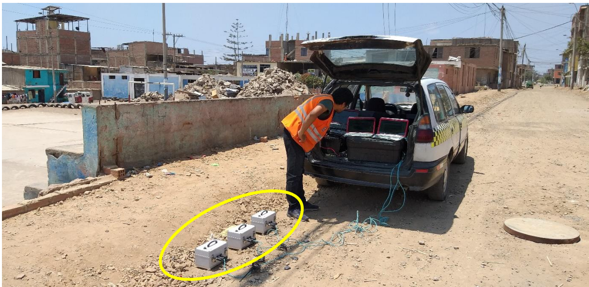
FOTO M-06: Se muestran los sensores, los cables y el equipo adquisidor de señales usado para la medición de microtemores frente al centro de salud municipal Warmi.
