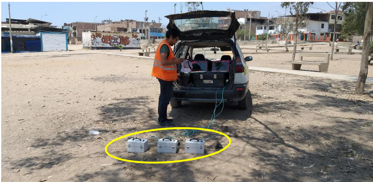
FOTO M-08: Se muestran los sensores y adquirente de datos en el momento del registro de la vibración ambiental, realizado en el parque sector 3 grupo 27.
