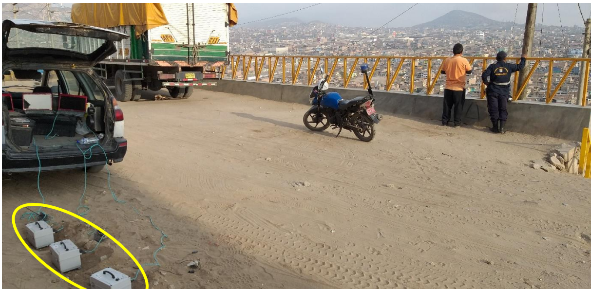
FOTO M-16: Se observa el instante de la toma de datos de los registros de microtemores captados mediante tres sensores. La medición se ejecutó en el AA.HH Bello horizonte ubicado en el Cerro Papa.
