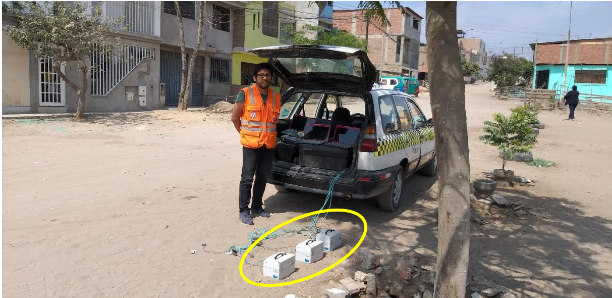
FOTO M-09: Se observa momento de medición de la vibración ambiental en el parque Sur ubicado a una cuadra de la Av. María Elena Moyano.
