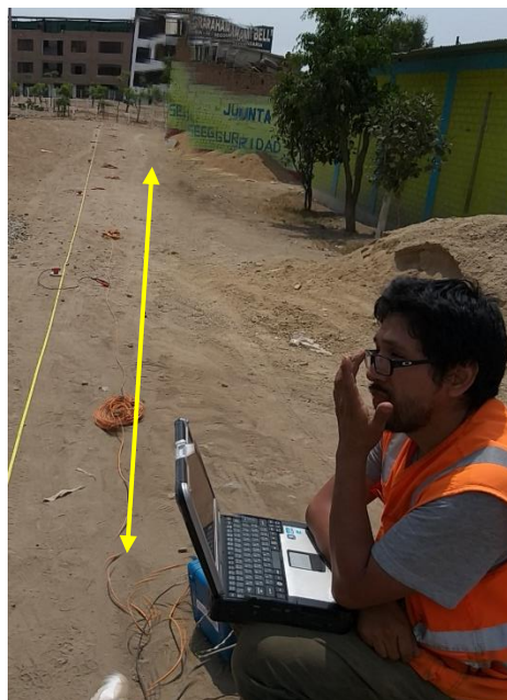
FOTO MASW-MAM 04: Se observa el tendido de cables y su conexión con los geófonos para el ensayo MASW frente al Parque del Grupo 26.
