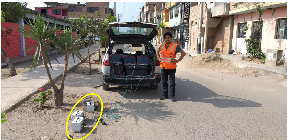
FOTO M-12: Se observa el instante del registro de las ondas de microtemores. El ensayo fue realizado en el sector 2 grupo 9 entre las avenidas Juan Velasco Alvarado y Jorge Chavez.
