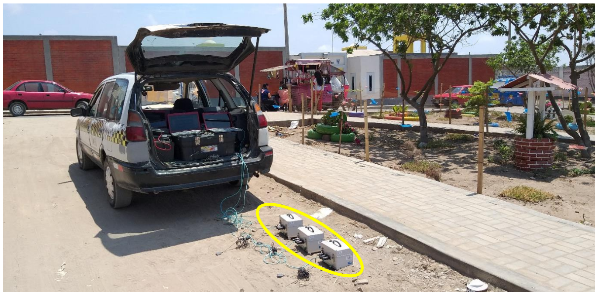
FOTO M-03: Se muestra la disposición del equipo de medición de microtemores (tres sensores, cables, adquirente de datos), al costado del Parque Jacaranda en la calle Las Acacias.
