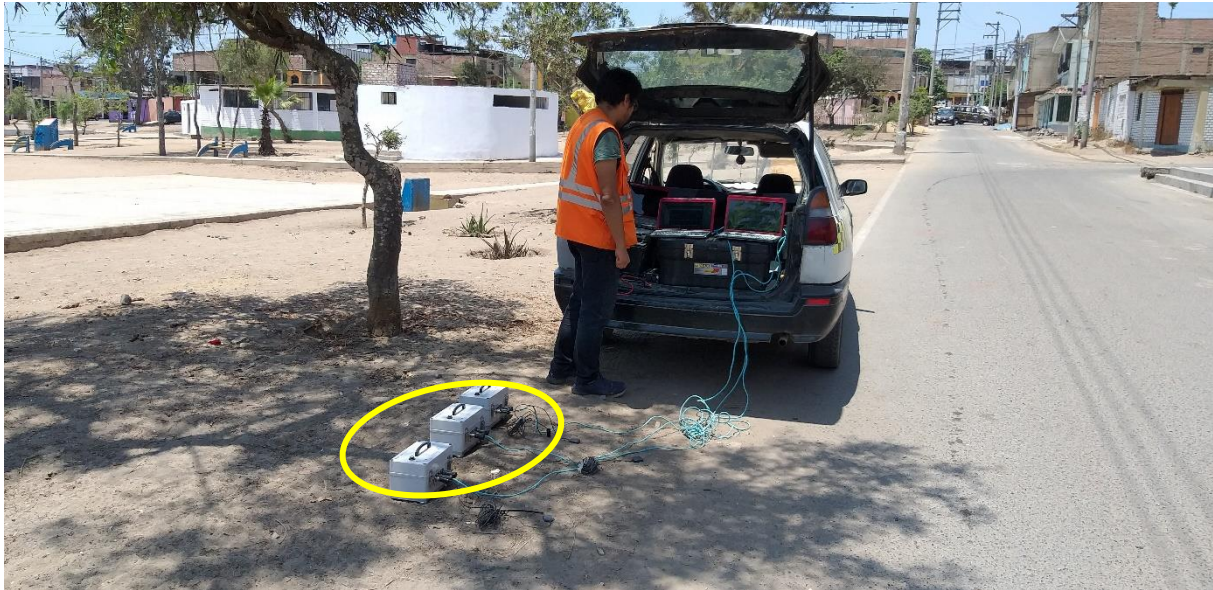
FOTO M-05: Se muestra el instante de la medición de microtemores, realizado en la parque del sector 3 grupo 18.
