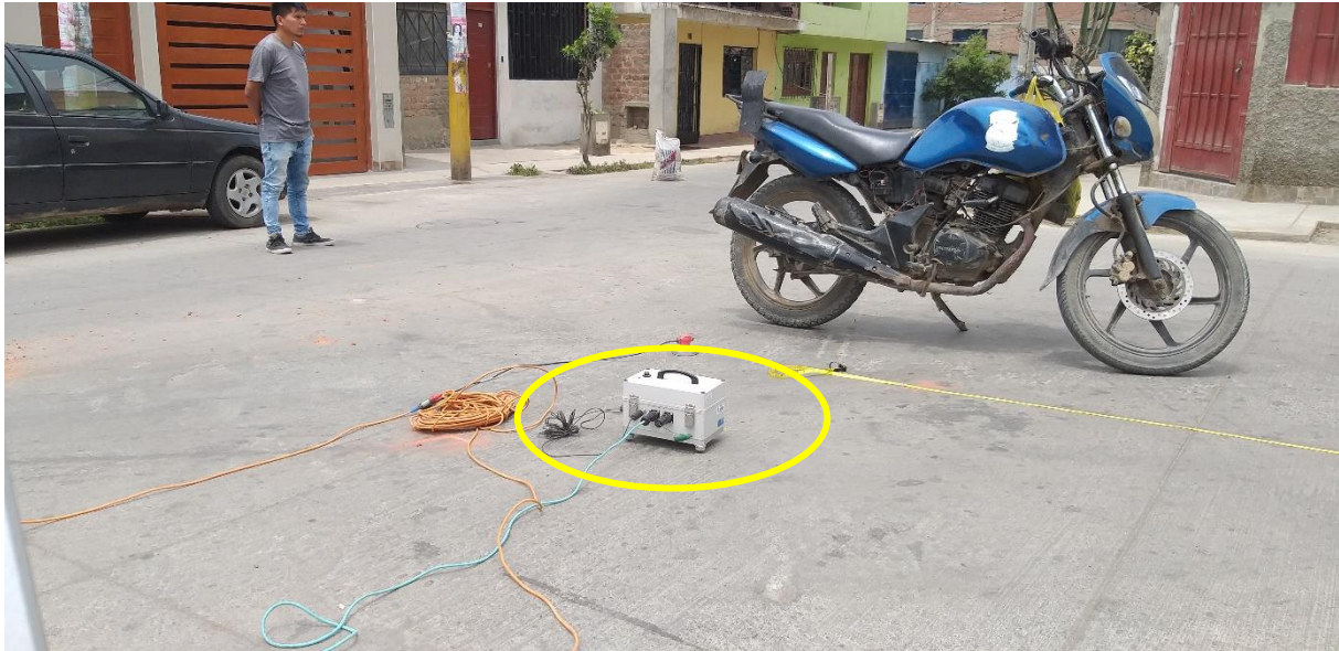
FOTO M-17: Se observa la ubicación de los sensores, para el registro de microtemores. El ensayo se ejecutó el parque del sector 2 grupo 18 ubicado a espaldas del puesto de salud Sagrada Familia.
