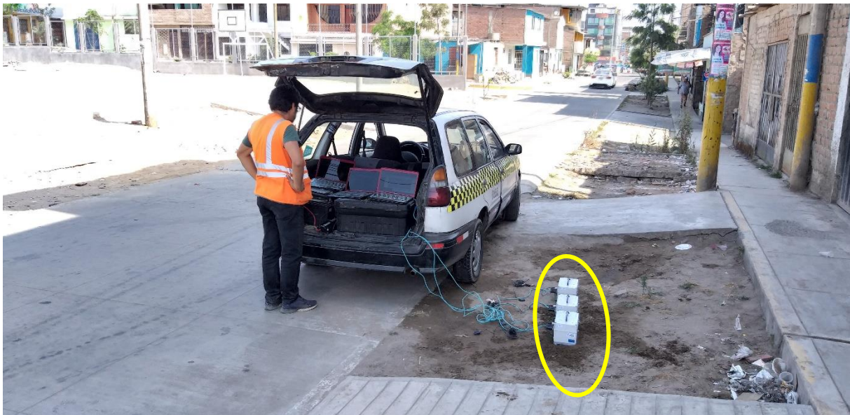
FOTO M-11: Se muestran los sensores y los cables usados para la medición de la vibración ambiental del suelo, realizado a espaldas del colegio Francisco Bolognesi 6064.
