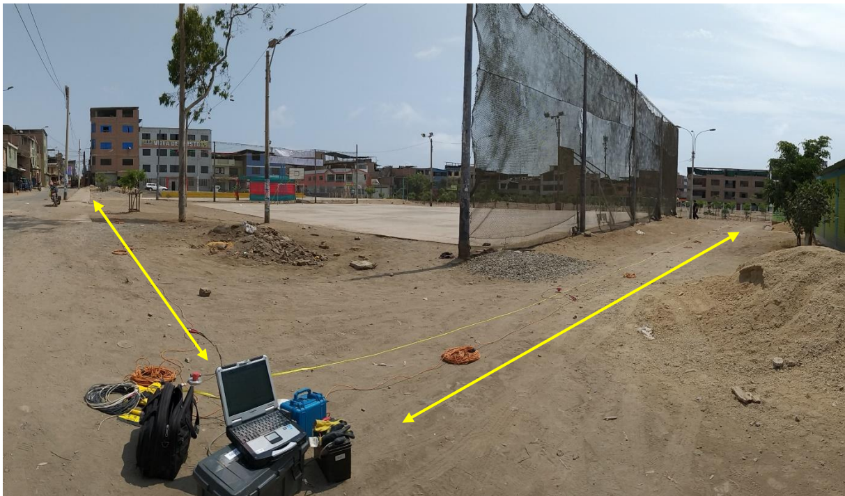
FOTO MASW-02: Ejecución del ensayo MASW en parque del sector 2 grupo 8 ubicado frente al instituto educativo Villa de Cristo. Se observa sismógrafo, adquisidor de data y extensión de cables con geófonos.
