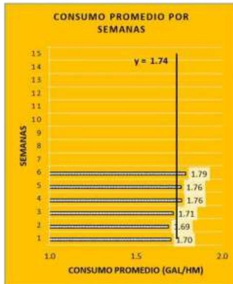
**Figura N°70** Combustible (GAL/HM) de la retroexcavadora
