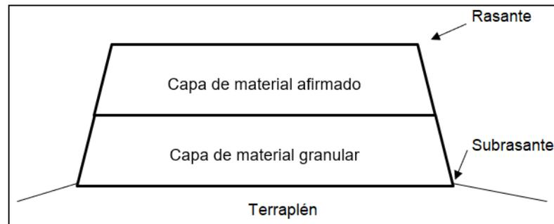
**Figura N°22** Sección típica de la conformación de rasante
