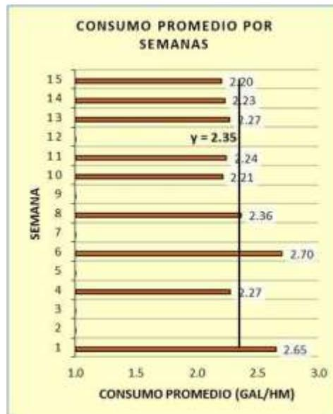
**Figura N°71** Combustible (GAL/HM) del camión cisterna
