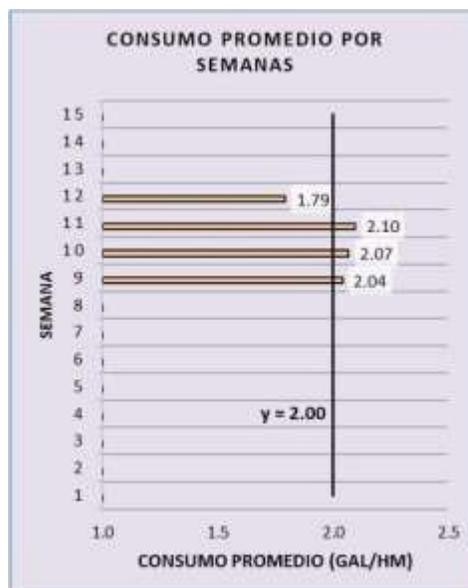
**Figura N°76** Combustible (GAL/HM) de volquete-T2W-920
