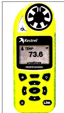
Figura 3.2: Termohigroanemometro digital, Kestrel 5200
