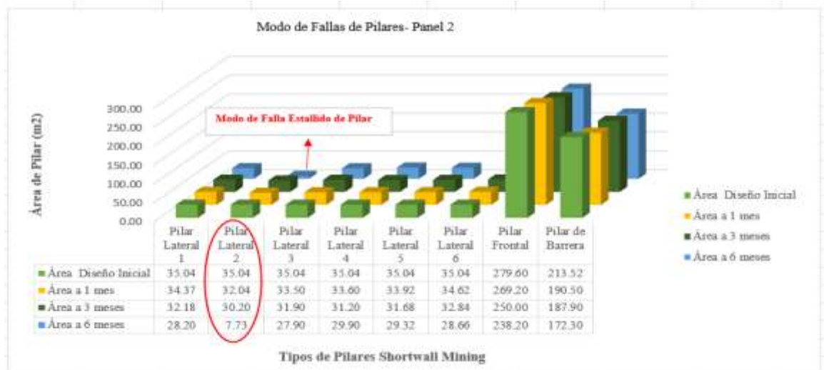
Fig. 3.9: Modos de falla de los pilares en los paneles sucesivos al panel 2
