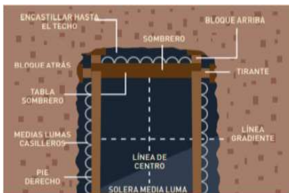
Fig. 2.12: Elementos del cuadro de madera
