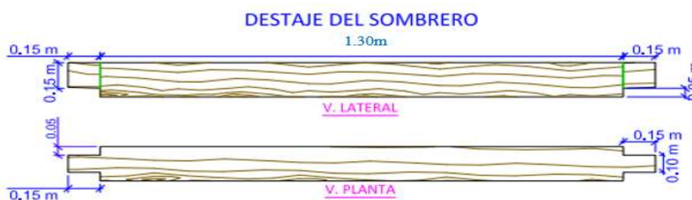
Fig. 3.16: Rebaje de los sombreros de madera
