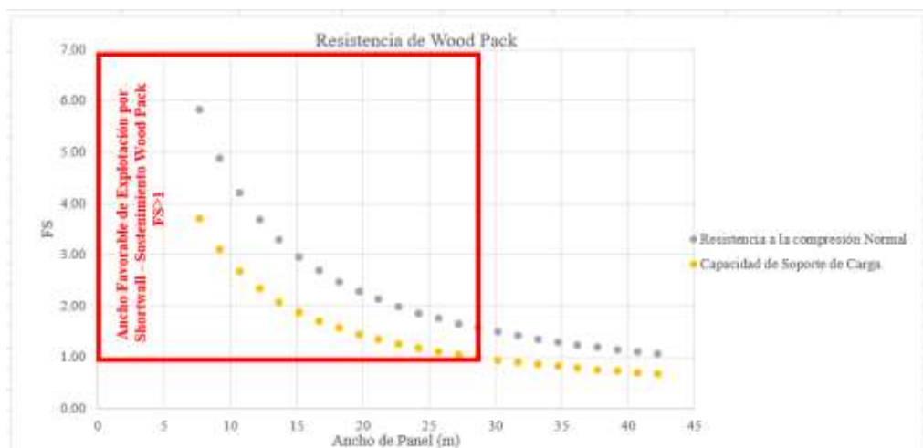
Fig. 4.14: Ancho Máximo de excavación con Wood Pack
