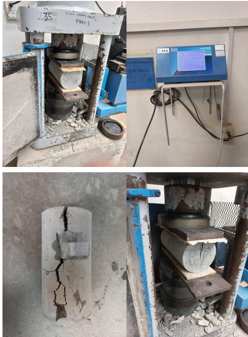
Ensayo al concreto en estado endurecido, compresión diametral, a la edad de 28 días, para los diferentes concretos elaborados, realizado en el laboratorio LEM - UNI.
