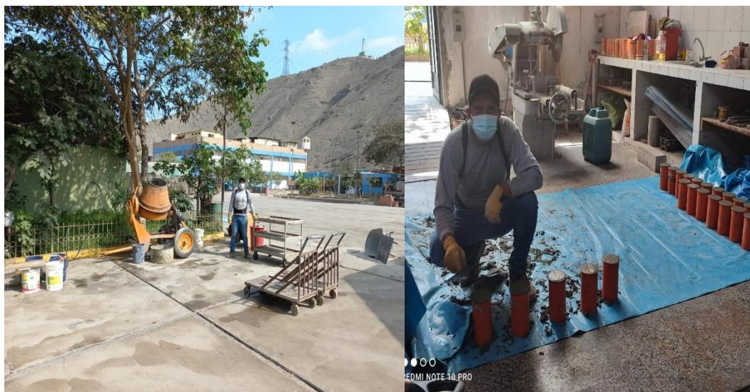
Ensayo maxima compacidad del agregado global y ensayo de abrasion, piedra.
