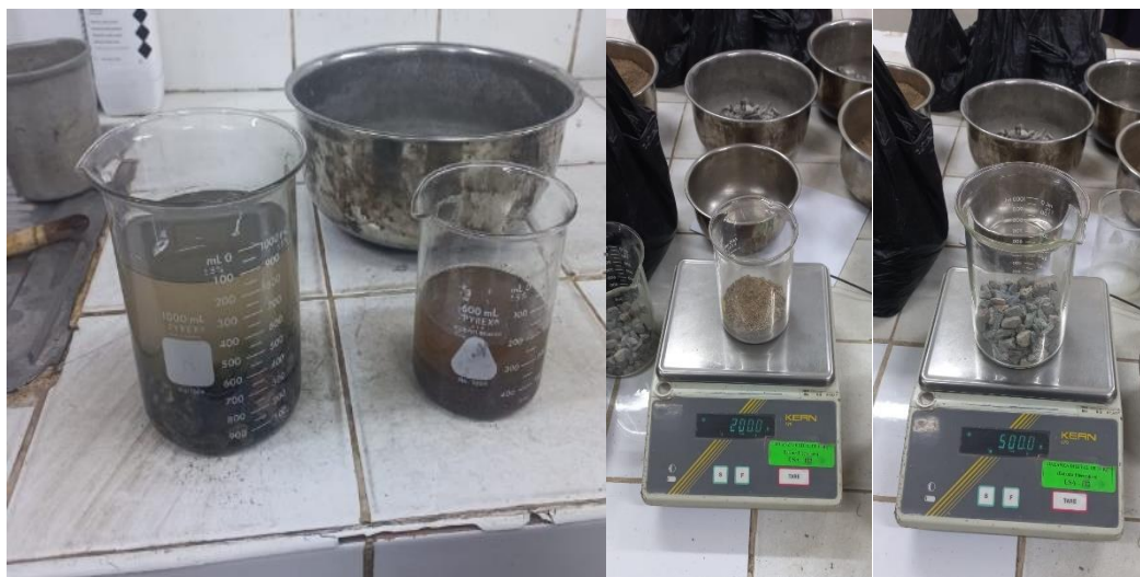
Ensayo de partículas livianas, piedra y arena.
