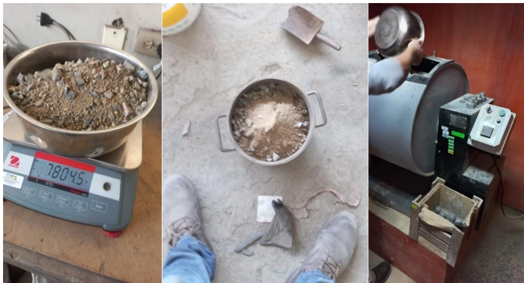
Ensayo maxima compacidad del agregado global y ensayo de abrasion, piedra.
