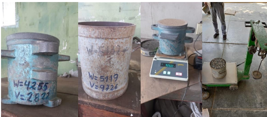
Materiales y pesaje de peso unitario suelto y compactado, arena y piedra.
