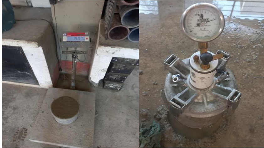
Ensayo en estado fresco al concreto: peso unitario y contenido de aire, realizado en el laboratorio LEM - UNI.
