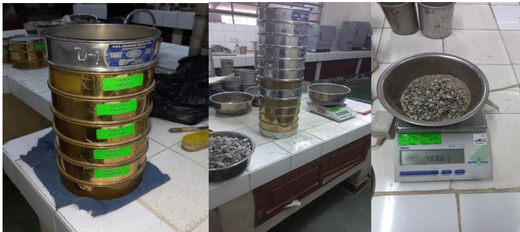
Tamices para ensayo de granulometría arena y piedra. Pesaje de peso retenido.
