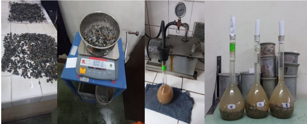
Ensayo de peso específico de masa y absorción, arena y piedra.
