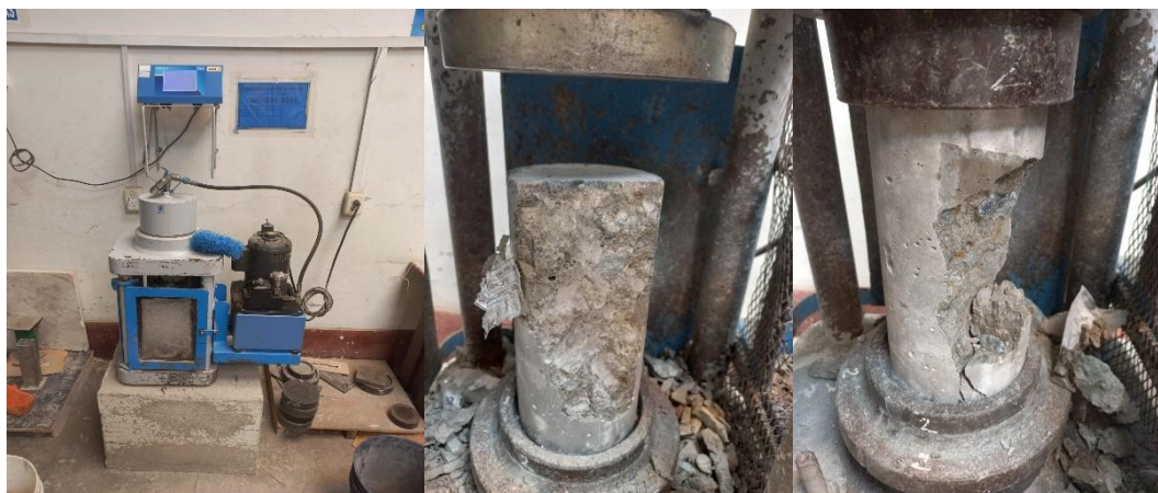
Ensayo al concreto en estado endurecido, compresión axial, a las edades de 7, 14, 28, 60 y 90 días, para los diferentes concretos elaborados, realizado en el laboratorio LEM - UNI.
