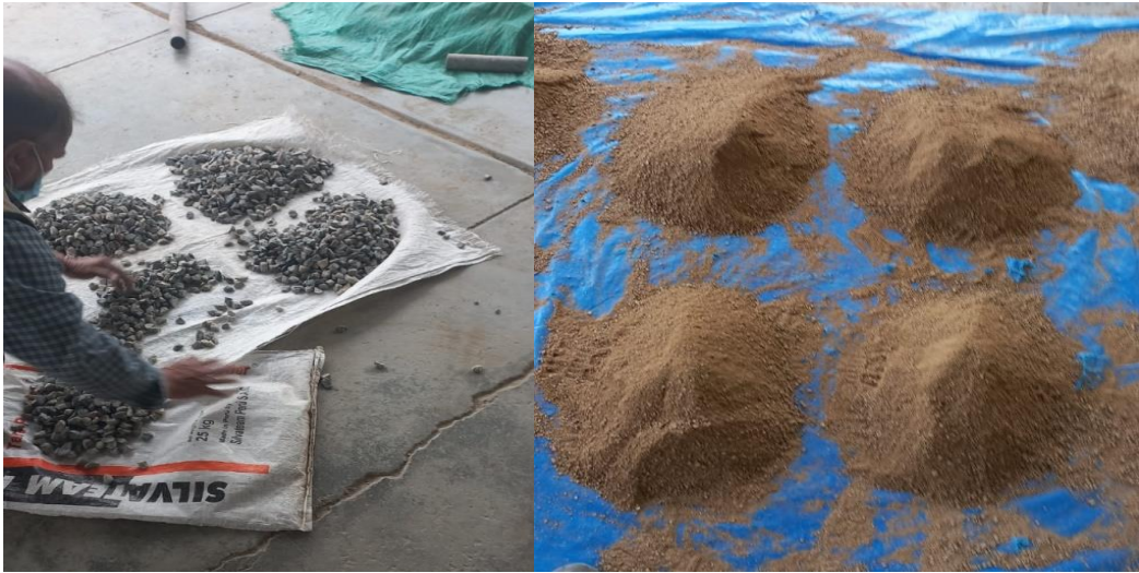
Cuarteo de la piedra y arena de la cantera de Jicamarca.
