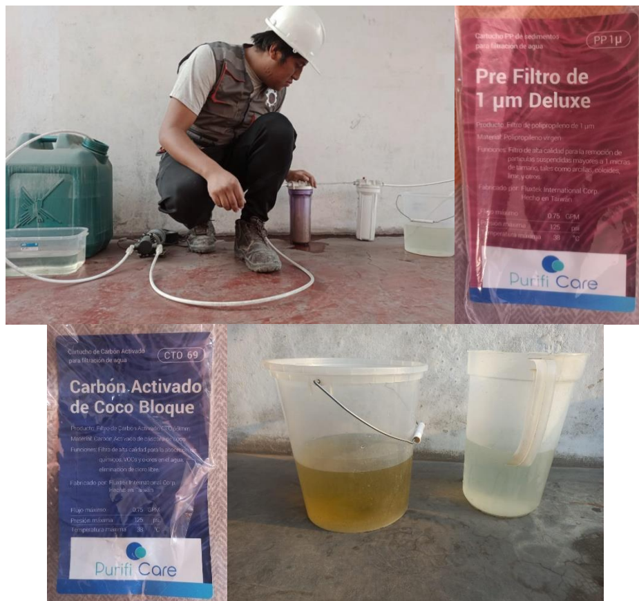
Proceso adicional de filtrado del agua residual tratada, a través de filtros de cartucho y obtención del agua filtrada (AF)
