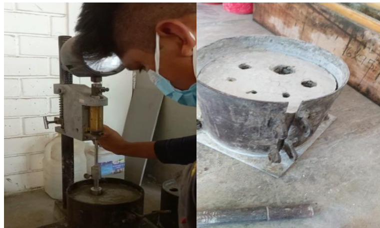
Ensayo en estado fresco al concreto: tiempo de fraguado, realizado en el laboratorio LEM - UNI.
