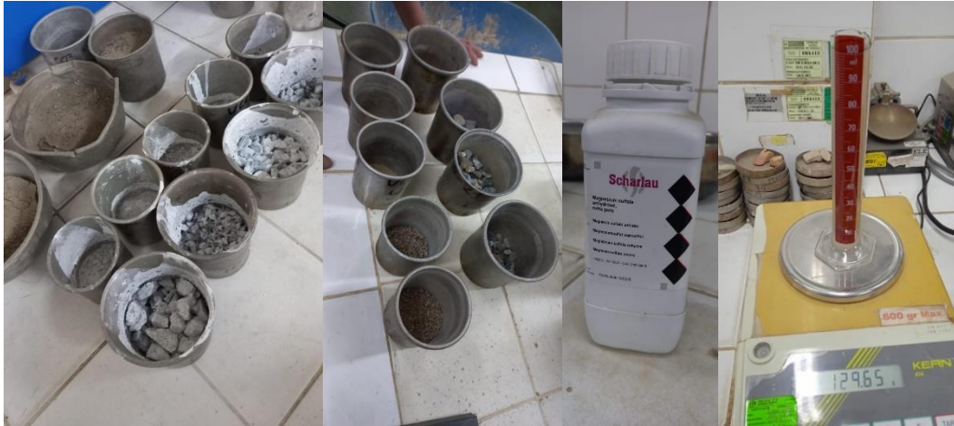
Ensayo de ineltarabilidad de arena y piedra frente al sulfato de magnesio.
