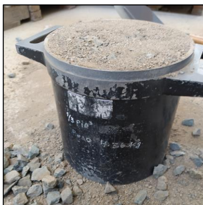
Figura 15 Combinación de agregados para obtener su peso unitario compactado.
