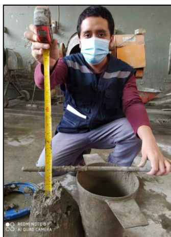
Figura 20 Ensayo de asentamiento. Medición.
