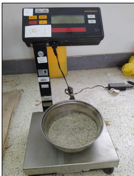
Figura 9 Ensayo del material más fino que atraviesa la malla N° 200. Peso seco de la muestra original.
