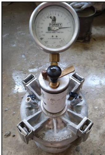
Figura 25 Aparato usado para medir el contenido de aire en concreto fresco.
