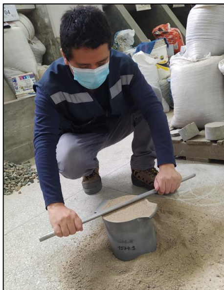
Figura 12 Ensayo de peso unitario suelto del agregado fino. Procedimiento de enrasado previo a pesar el recipiente con el agregado.
