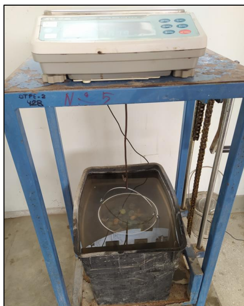
Figura 11 Ensayo de peso específico y absorción del agregado grueso. Peso de la muestra sumergida en agua.
