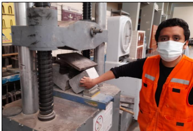
Figura 45 Viga después del ensayo de resistencia a flexión.
