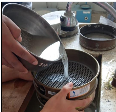
Figura 8 Ensayo del material más fino que atraviesa la malla N°200. Operación de lavado del material.
