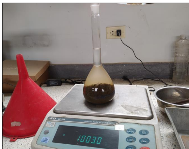
Figura 10 Ensayo de peso específico y absorción del agregado fino. Peso de la muestra superficialmente seca N°1, el picnómetro y el agua.
