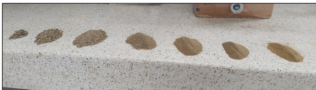
Figura 4 Material que pasa por cada tamiz del ensayo granulométrico del agregado fino natural.
