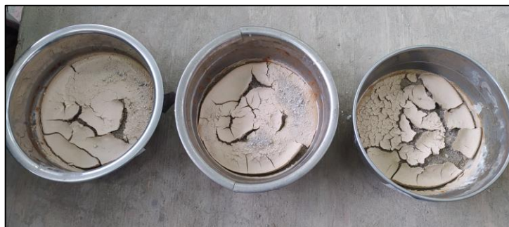
Figura 14 Ensayo de contenido de humedad de agregado fino reciclado. Peso de la muestra seca.
