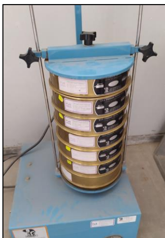
Figura 3 Aparato para ensayo de granulometría de agregado fino.
