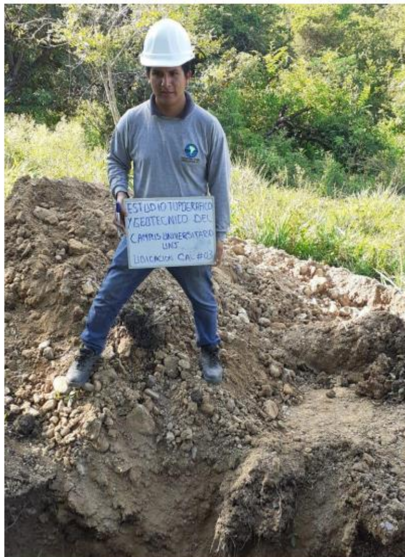
FOTOGRAFIA 03: Muestra la Ubicación de la Calicata C - 3, con presencia de vegetación y raíces, además se aprecia el material extraído. siendo una Grava limosa. de color marrón
