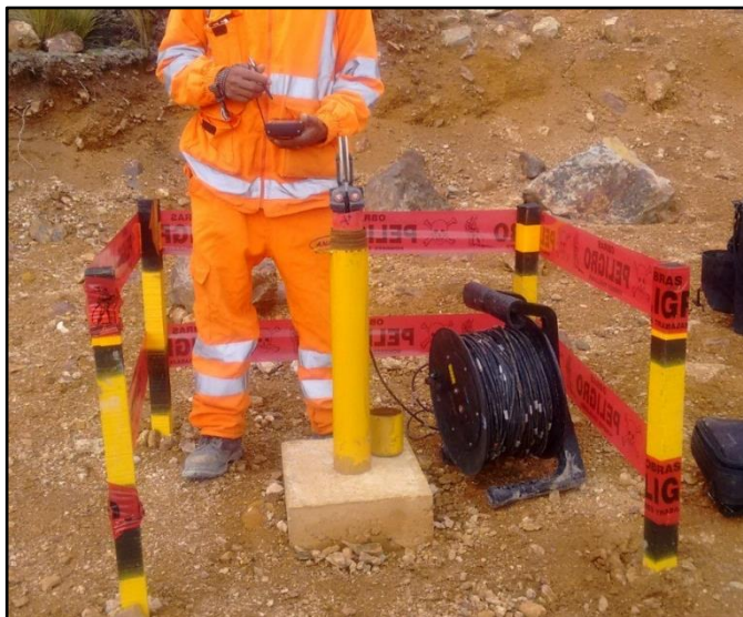
Figura 7,5 Ejemplo de toma de datos de inclinómetros.
