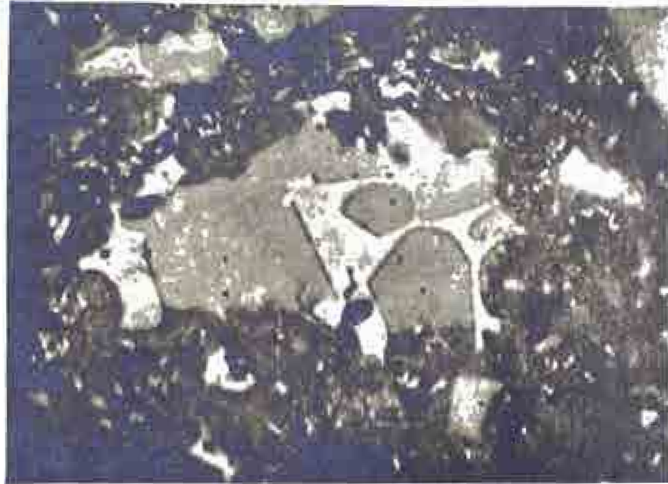
.—Una pasta de cemento hidratada durante veintiocho días, mostrando cristales de C_3S sin hidratar, otros de C_2S parcialmente hidratados y material intersticial sin hidratar. \times 900 . ( Brownmiller. )
