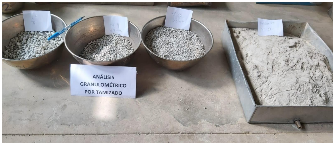
Figura 4.6. Análisis granulométrico del RC-DTP Fuente: Elaboración propia
