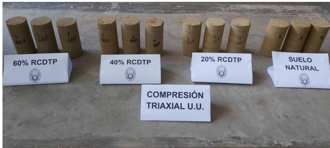
Figura 4.22. Especímenes preparados para ensayo triaxial de suelo natural, 20 %, 40 % y 60 % de RCDTP.
