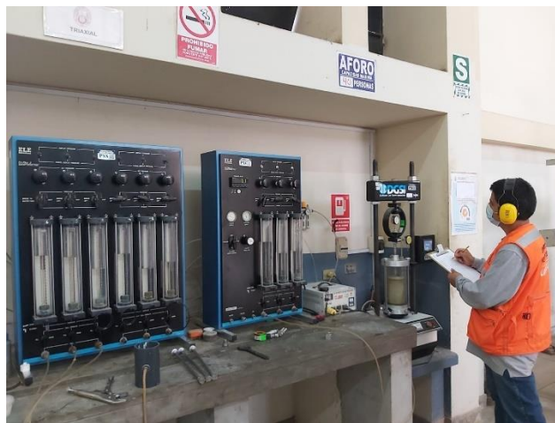
Figura 4.20. Equipo de compresión triaxial usado en el ensayo
