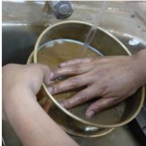
Figura 4.5. Lavado a través del tamiz N°200
