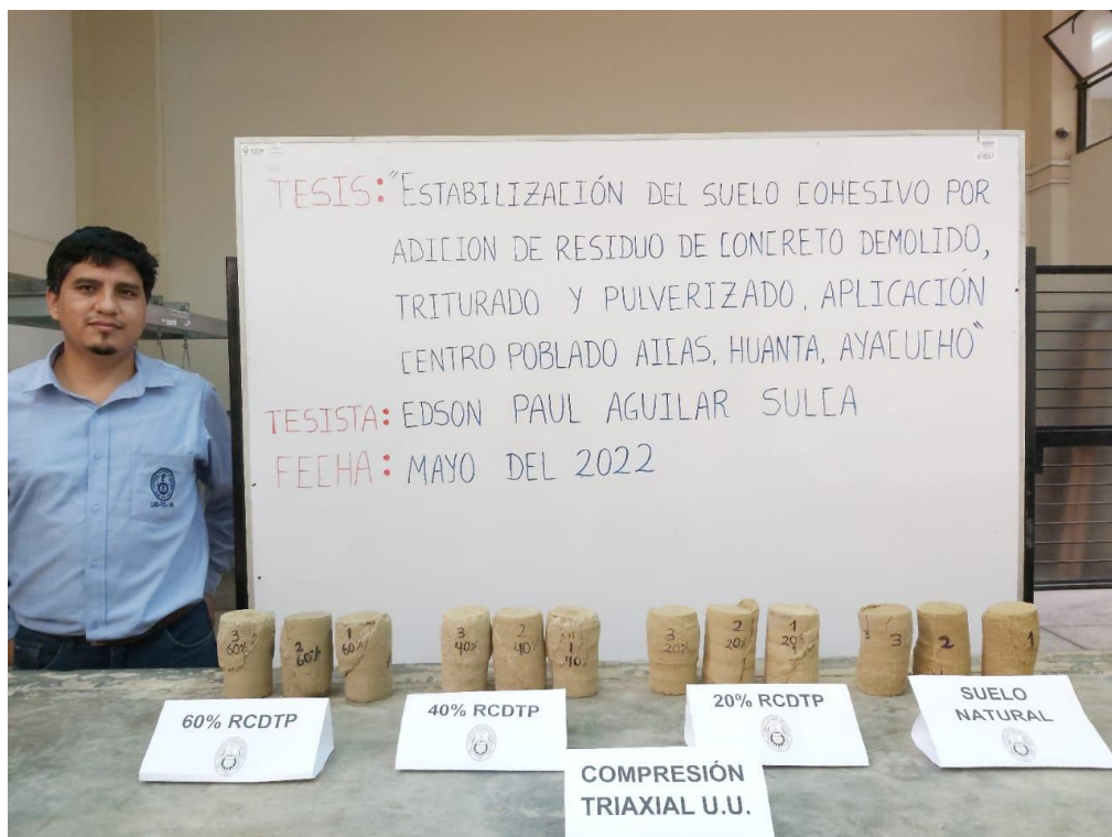
Figura 5.5. Especímenes después del ensayo triaxial para diferentes concentraciones de RCDTP.
