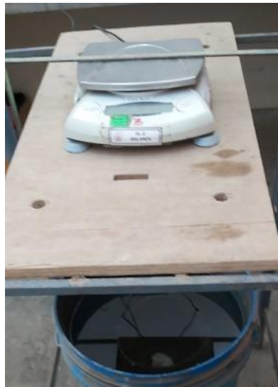
Figura 4.16. Registro del peso aparente de la muestra parafinada Fuente: Elaboración propia
