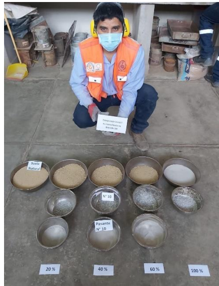
Figura 4.19. Dosificación del suelo y RCDTP para ensayo triaxial
