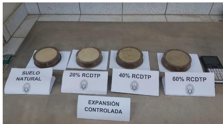
Figura 4.25. Especímenes remoldeados ensayo de expansion controlada.
