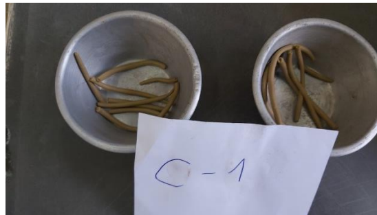
Figura 4.10. Rollitos del ensayo límite plástico
