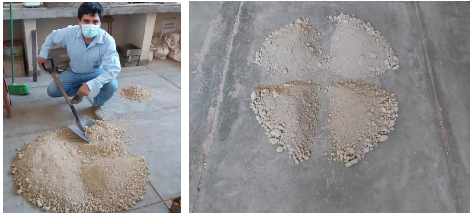
Figura 4.3. Cuarteo de la muestra de suelo
