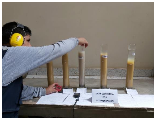
Figura 4.7. Granulometría por sedimentación
