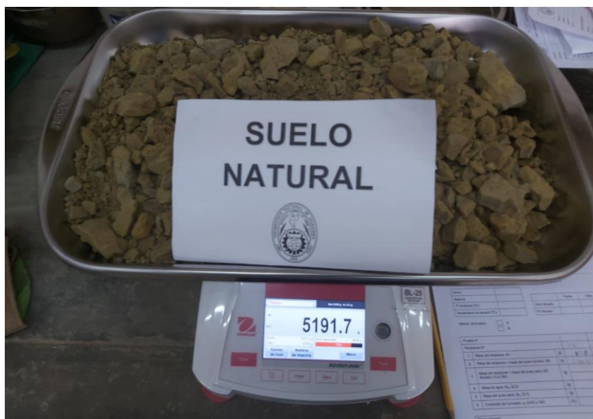
Figura 4.13. Muestra húmeda del suelo natural para determinar del contenido de humedad.
