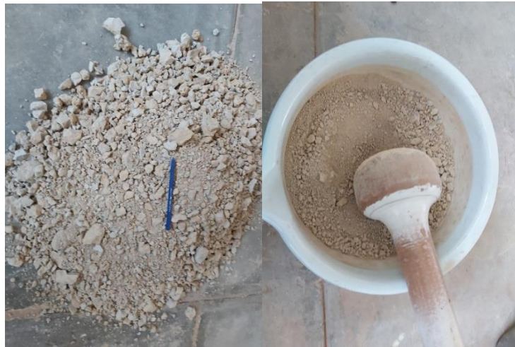
Figura 4.4. Disgregación de los terrones de arcilla
