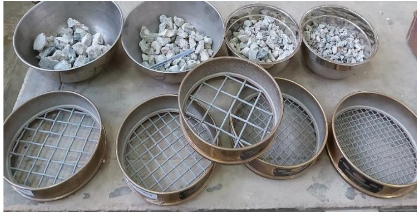
Figura 4.2. Muestra para realizar el ensayo de abrasión del concreto Fuente: Elaboración propia.
