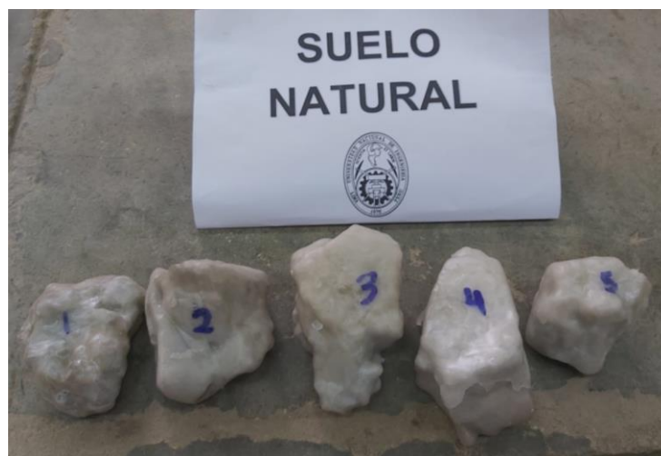
Figura 4.15. Parafinado del espécimen
