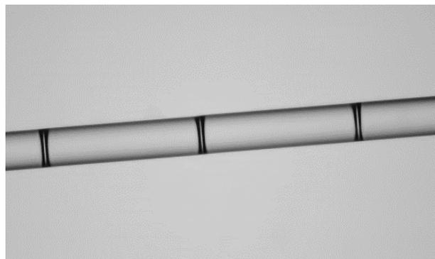
Figura N° 4.14 Sensor LPG fabricado con 3 periodos en una fibra SMF comercial. Fuente propia
