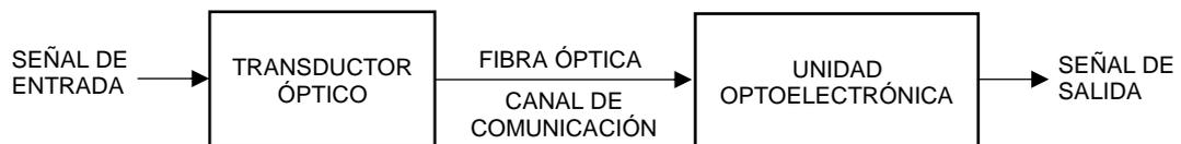
Figura N° 2.21 Componentes de un sensor de fibra óptica. Adaptado de Criollo (2015)
