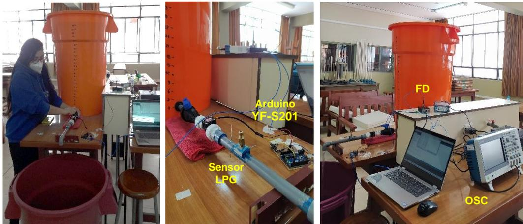
Figura N° 4.31 Arreglo experimental para la medición de flujo en una tubería con sensor LPG.
