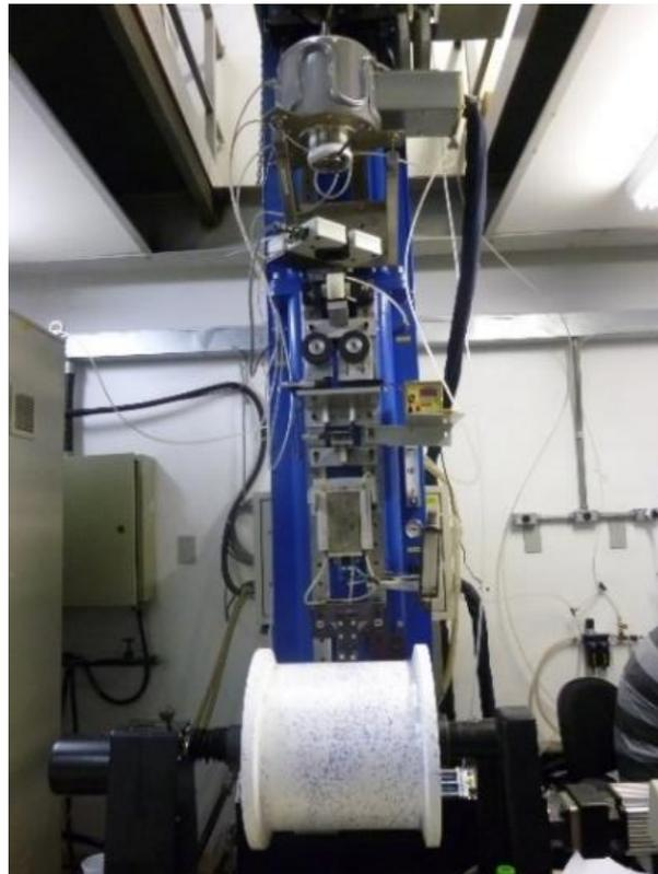
Figura N° 2.20 Torre de estiramiento de preformas mPOF. Tomado por Mosquera (2019)
