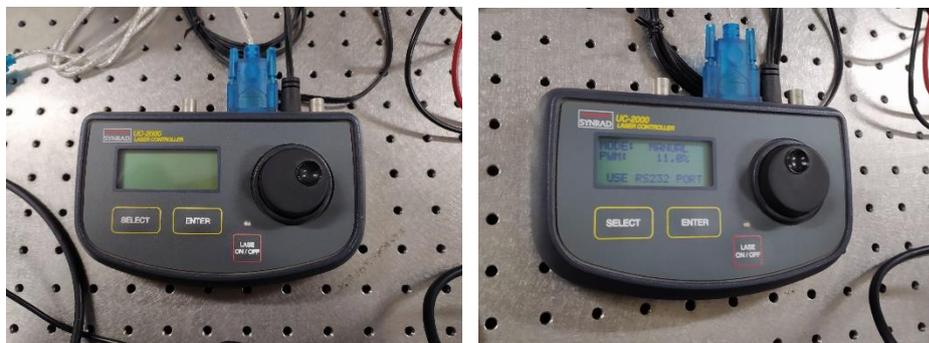
Figura N° 3.7 Controlador de láser UC-2000. Fuente propia
