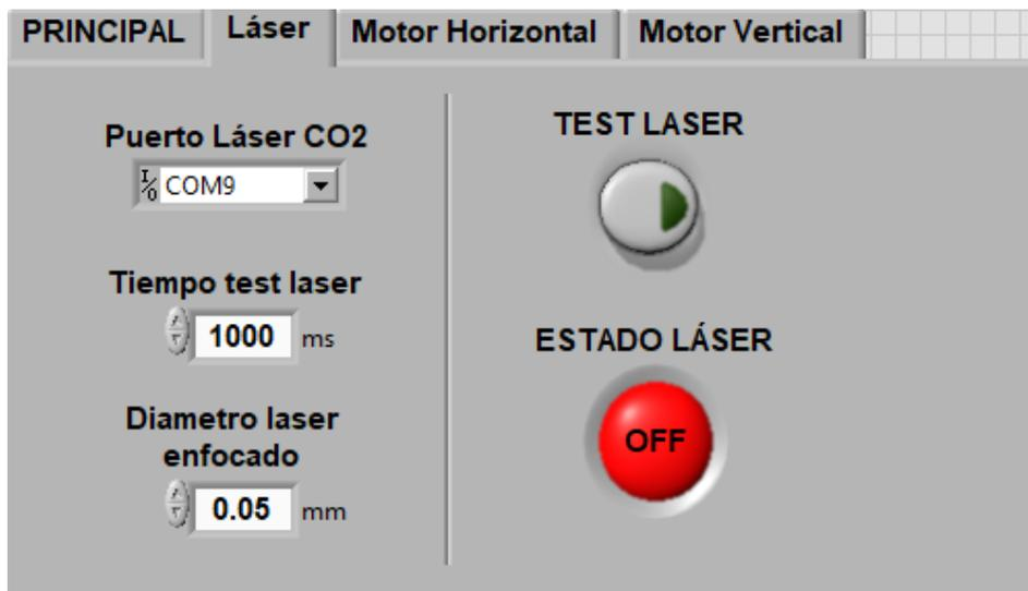
Figura N° 3.21 Interfaz para el control de láser CO<sub>2</sub>. Fuente propia
