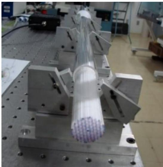
Figura N° 2.19 Capilares apilados con núcleo de sílice. Tomado por Mosquera (2016)
