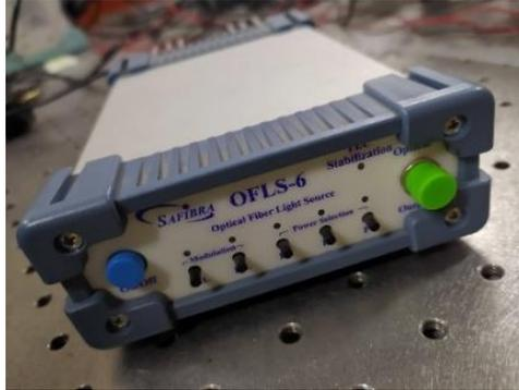
Figura N° 3.16 Fuente de Luz LED Safibra modelo OFLS-6. Fuente propia
