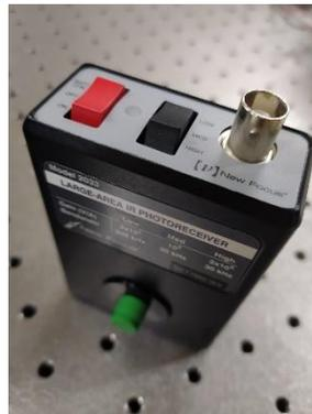
Figura N° 3.17 Fotodetector Newport modelo 2333. Fuente propia
