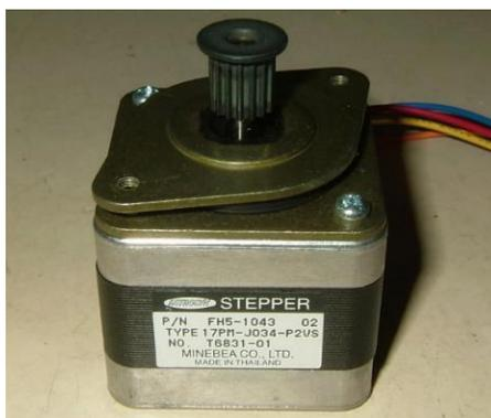
Figura N° 3.10 Motor a pasos para movimiento vertical. Tomado por Trigo (2021)
