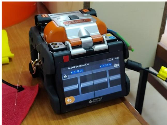
Figura N° 3.15 Empalmadora Sumitomo Type-82C. Fuente propia
