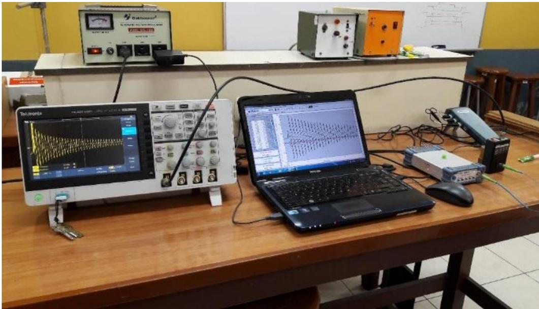
Figura N° 3.29 Respuesta dinámica del sensor de fibra óptica tipo LPG. Fuente propia
