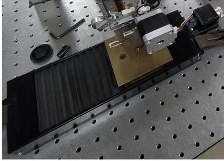
Figura N° 3.8 Base Móvil Horizontal. Fuente propia
