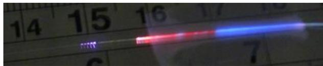
Figura N° 3.26 Luz guiada en una red LPG de 5 periodos de 500 $\mu$ m. Mosquera 2014
