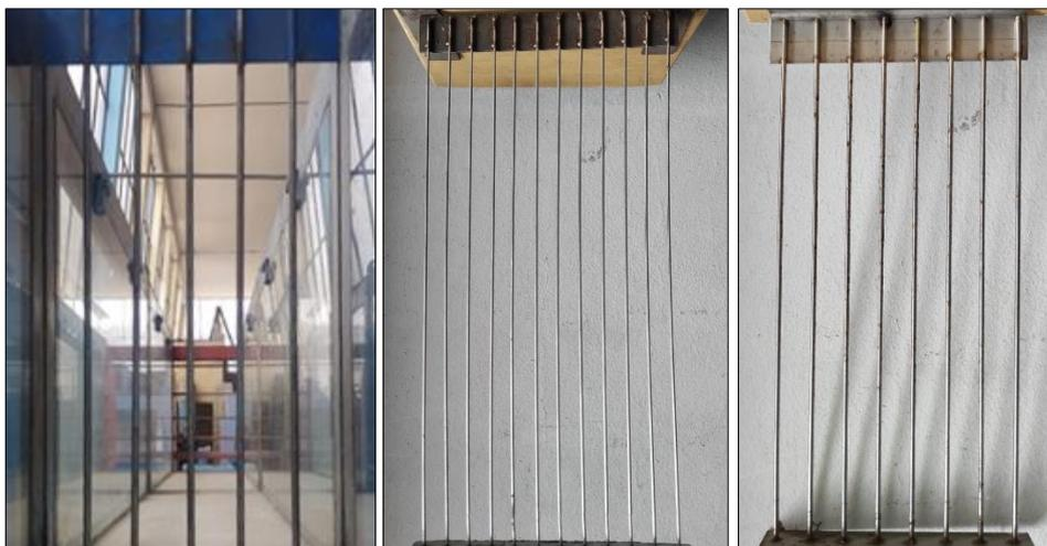
Figura N° 26 Rejillas de retención de troncos (Elaboración propia)
