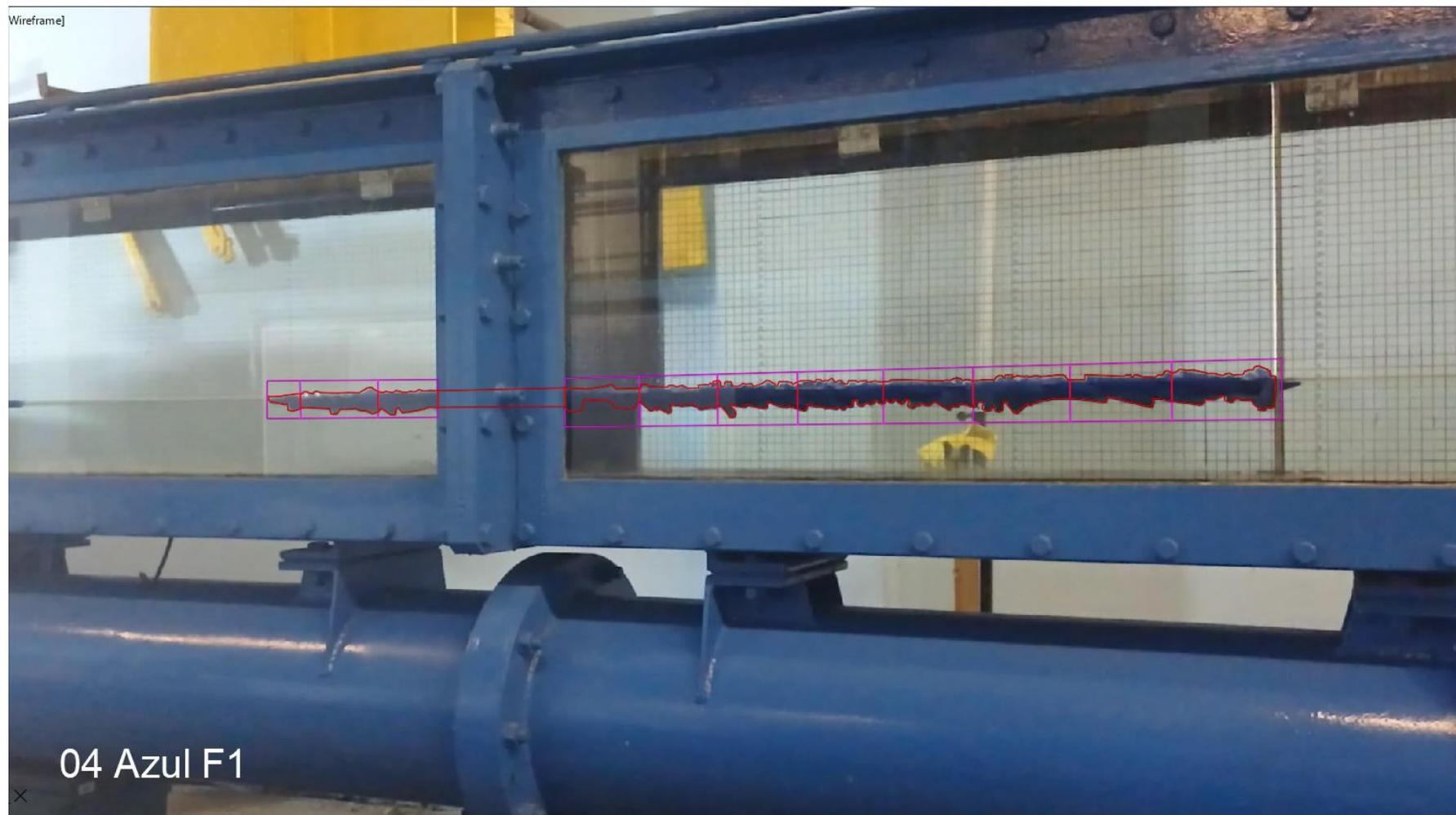
Fotografía 03: Análisis videométrico para la acumulación con  $Fo= 0.2$ ,  $\rho_T=600 \text{ kg/m}^3$ ,  $A_L = 298.55 \text{ cm}^2$ .
