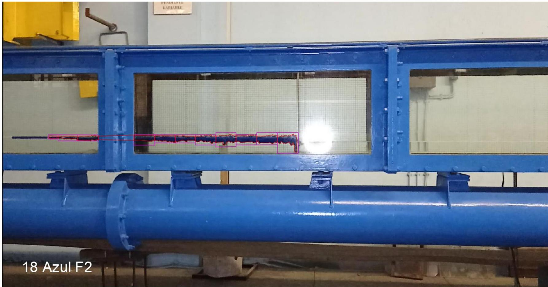
Fotografía 16: Análisis videométrico para la acumulación con  $Fo= 0.3$ ,  $\rho_T=600 \text{ kg/m}^3$ ,  $A_L = 634.46 \text{ cm}^2$ .
