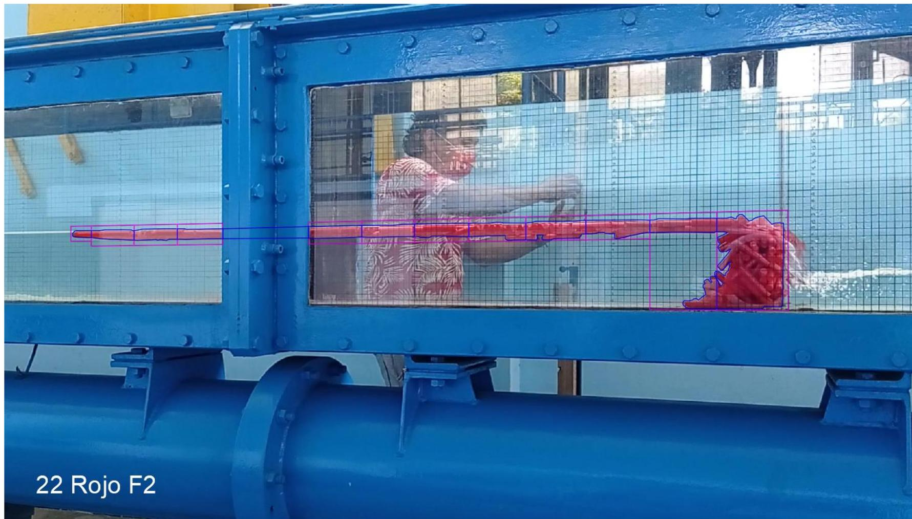
Fotografía 20: Análisis videométrico para la acumulación con  $Fo= 0.3$ ,  $\rho_T=950 \text{ kg/m}^3$ ,  $A_L = 789.91 \text{ cm}^2$ .
