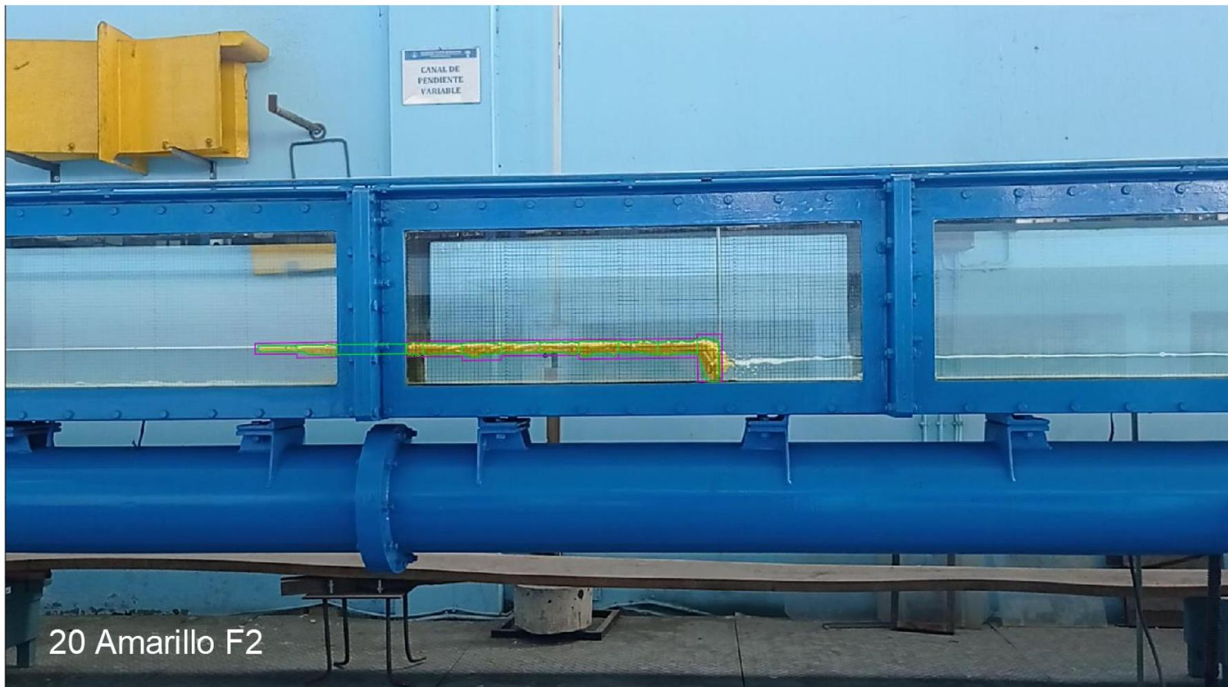
Fotografía 18: Análisis videométrico para la acumulación con  $Fo= 0.3$ ,  $\rho_T=600 \text{ kg/m}^3$ ,  $A_L = 703.32 \text{ cm}^2$ .
