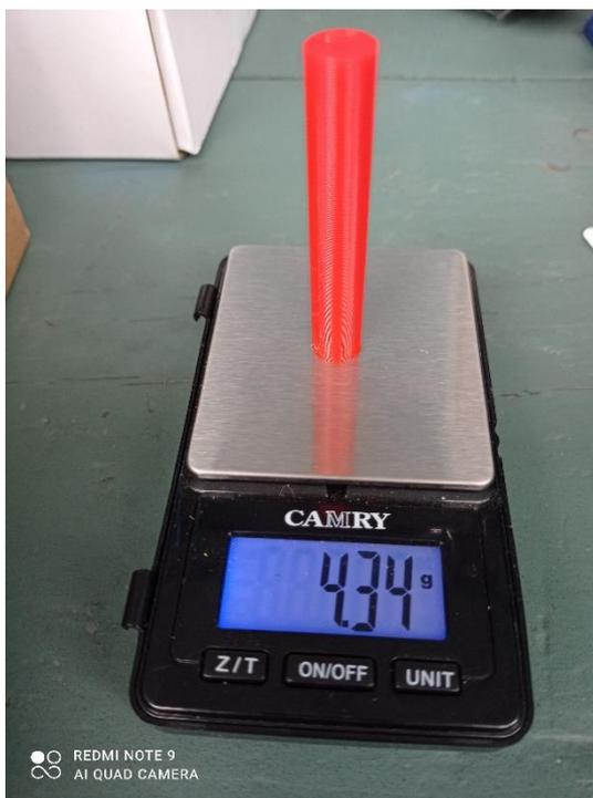
Figura N° 24 Tronco artificial de mayor densidad ( $\rho_T = 950 \pm 30 \text{ kg/m}^3$ ) (Elaboración propia)
