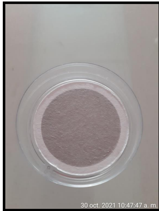
Fotografía 6. Filtro con muestra de PM2.5 en el portafiltro
