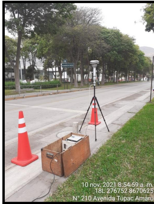
Fotografía 4. Muestreo de PM2.5 en el punto UNI-04
