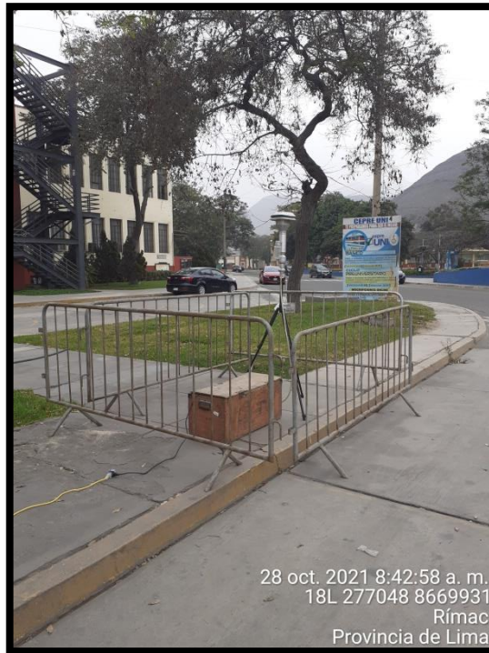
Fotografía 1. Muestreo de PM2.5 en el punto UNI-01
