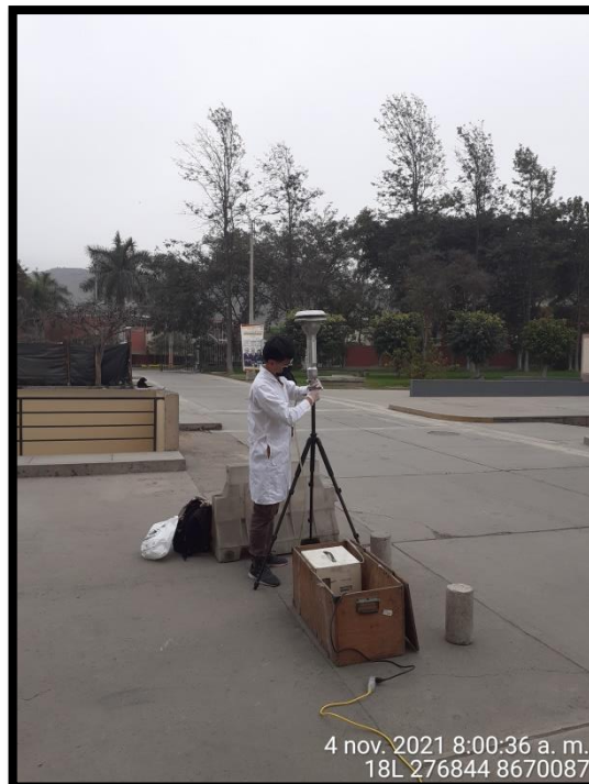
Fotografía 2. Muestreo de PM2.5 en el punto UNI-02
