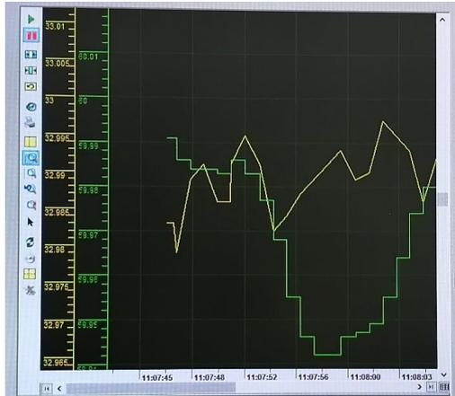
Fig. 32 Ejemplo del muestreo de la frecuencia (línea verde) en Subestación Convertidor 33KV - Arequipa, imagen tomada del SCADA de EGASA (Cortesía de EGASA)
