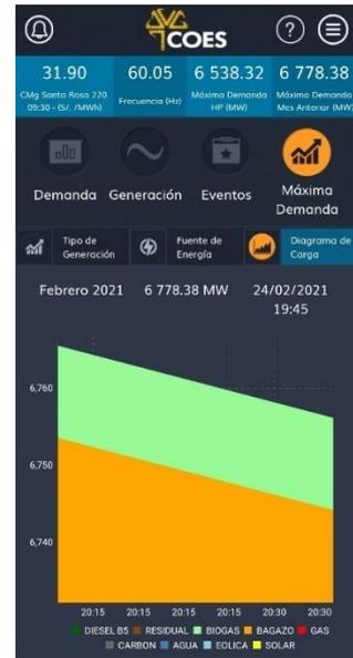
Fig. 29 Contorno del diagrama de carga (verde) con resolución temporal de 15 minutos; en la vertical, la demanda. Imagen tomada de la app del COES
