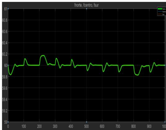
Fig. 34 Recreación computarizada de la frecuencia (Hz), usando el modelado matemático de los procesos, en un horizonte temporal de 1000 segundos y con cambios en la carga (demanda) de hasta +/- 10MW, similares a los que sufre el sistema eléctrico real. A diferencia del sistema real, las perturbaciones del modelado se dan cada 100 segundos.
