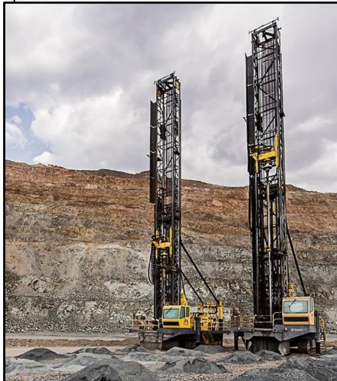
Perforadora Atlas Copco PV-351
