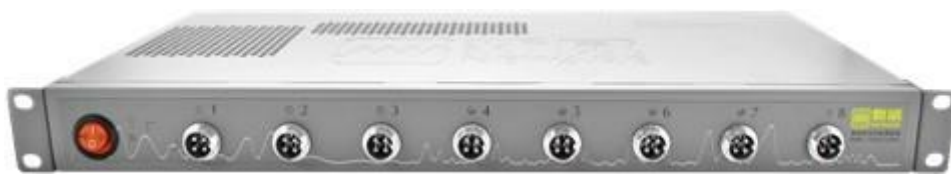
Figura 3.19: Equipo Neware BTS-4000 usado para medir las baterías.
