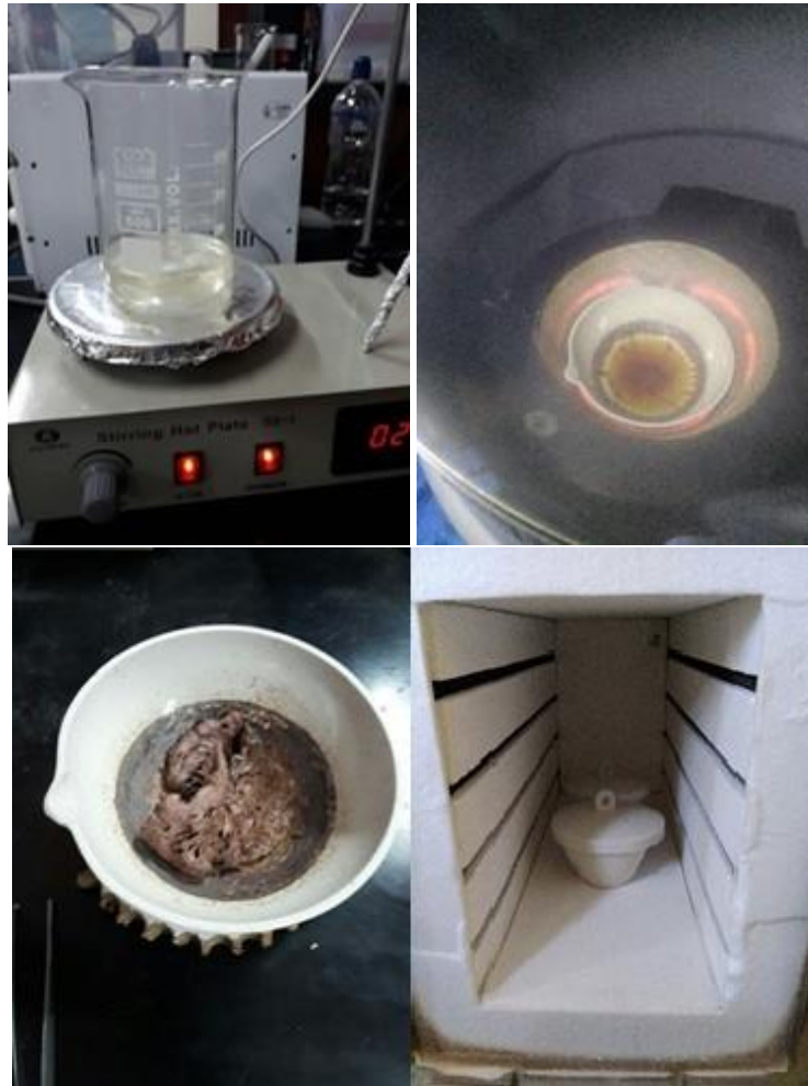
Figura 3.1: Pasos de la síntesis a) Mezclado de los materiales en agua desionizada, b) Secado de solución c) Formación de Nanopartículas de \text{BiFeO}_3 d) Tratamiento térmico de Nanopartículas de \text{BiFeO}_3 .
