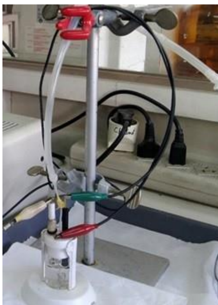
Figura 3.7: Armado y configuración de la celda electrolítica y los terminales del potenciostato.
