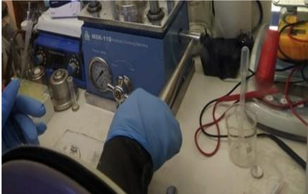
Figura 3.18: Lugar de trabajo para el armado de las baterías de Litio dentro de la cámara de vacío.
