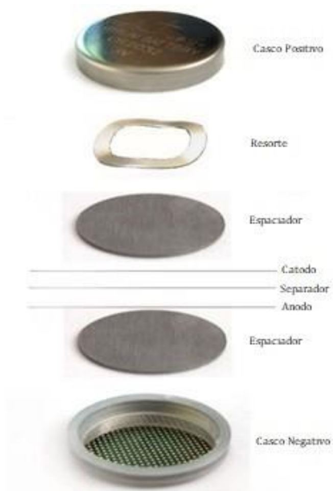
Figura 3.17: Partes de una pila de botón de Litio.
