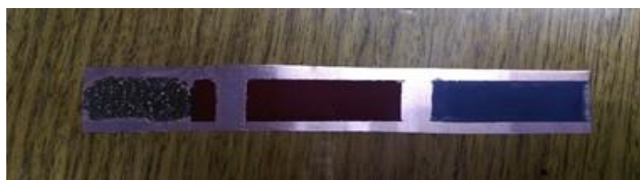
Figura 3.14: Materiales depositados sobre placa de cobre. A la izquierda Ortoferria de bismuto, al medio Oxido de fierro, y a la derecha Oxido de bismuto.
