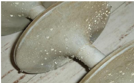
Fig. 2.4 Gotas de agua sobre aislador polimérico Fuente: (Tanushri Doshi, 2010, p. 10)
