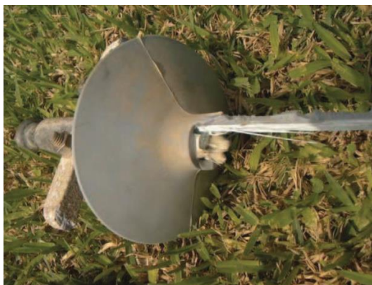
Fig. 2.5 Línea 220 kV Talara-Zorritos L-2249 P-09, aislador se rompió después de 7 años de operación. Fuente: (Loardo & Energía, 2010)
