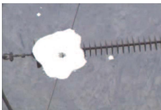
Fig. 2.9 Detección de descargas corona en Línea 220 kV L-2205 T-555 Pomacocha-San Juan Fuente: (Loardo & Energía, 2010)
