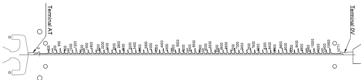
Fig. 4.6 Distancias acumuladas a lo largo de la superficie del aislador (Fuente: Elaboración propia)
