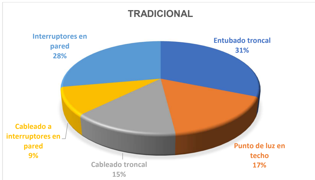
Figura N° 16 Incidencia instalación tradicional sin aplicación de domótica
