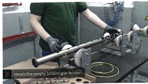
Figura 3 Inicio del armado de la escopeta. Fuente: Consejo Profesional Ingeniería Petróleos.
