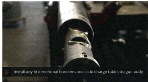
Figura 9 Instalación del boosters Fuente: Consejo Profesional Ingeniería Petróleos.
