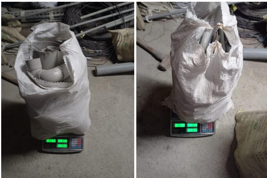
Figura N°38. Pesaje de los sacos con retazos de tuberías sanitarias
