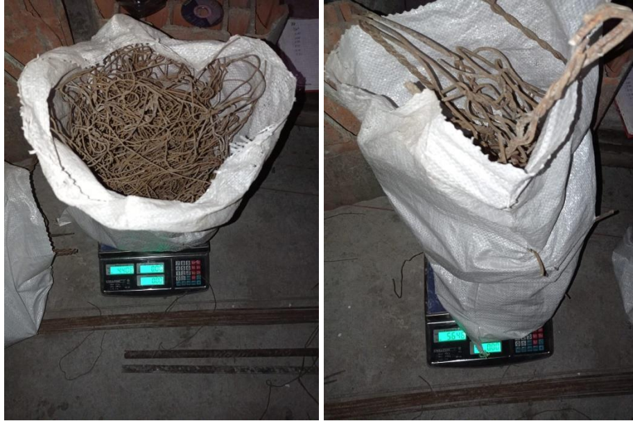
Figura N°21. Pesaje de los residuos de alambre
