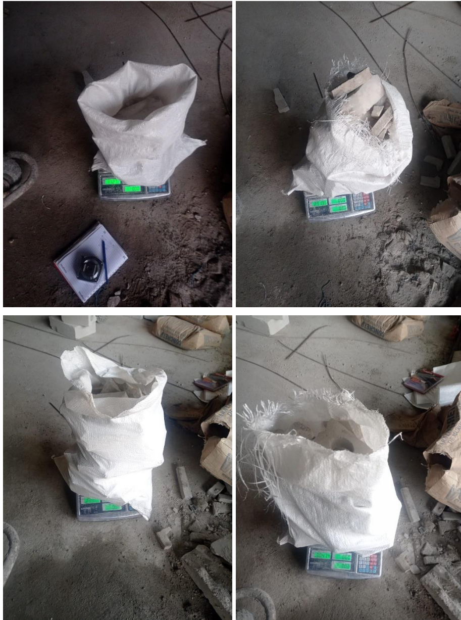
Figura N°33. Pesaje de residuos de ladrillo sílico - calcáreo
