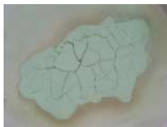
Figura N°29. Coprecipitación de Níquel y Galio con NH 3 (Hidróxido).
