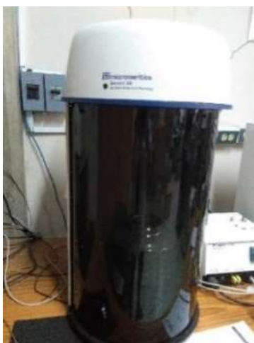
Figura N°31. Equipo GEMINI-VII determina las áreas superficiales de los catalizadores sintetizados.
