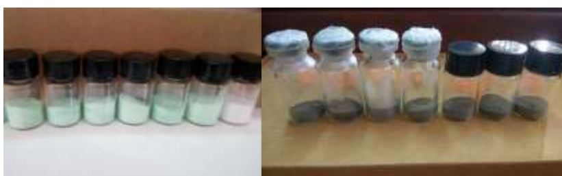
Figura N°30. Catalizadores antes de calcinar (Izquierda) y después de calcinar (Derecha).
