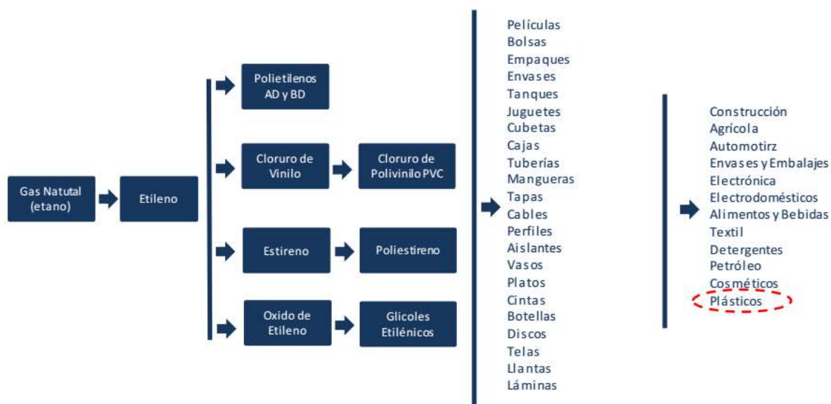
Figura N°11. Esquema de productos fabricados a partir de la materia prima (etileno) 70
