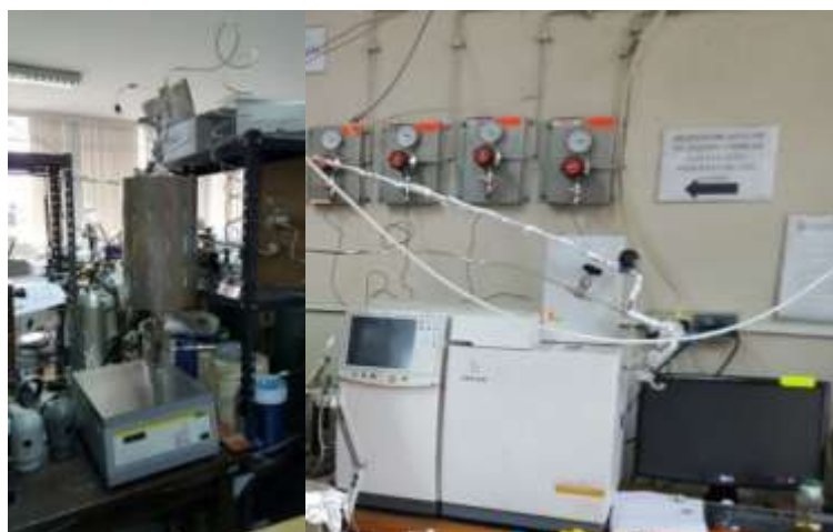
Figura N°26. Equipo Acoplado, Reactor (Izquierda) y CG (Derecha) ubicado en el laboratorio de fisicoquímica de la Universidad Nacional de Ingeniería.
