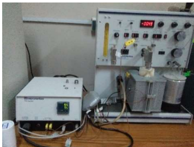
Figura N°32. Equipo TPx system de Micromeritics que determina las especies reducibles presentes en el catalizador, localizado en el laboratorio de Fisicoquímica de la Universidad Nacional de Ingeniería.
