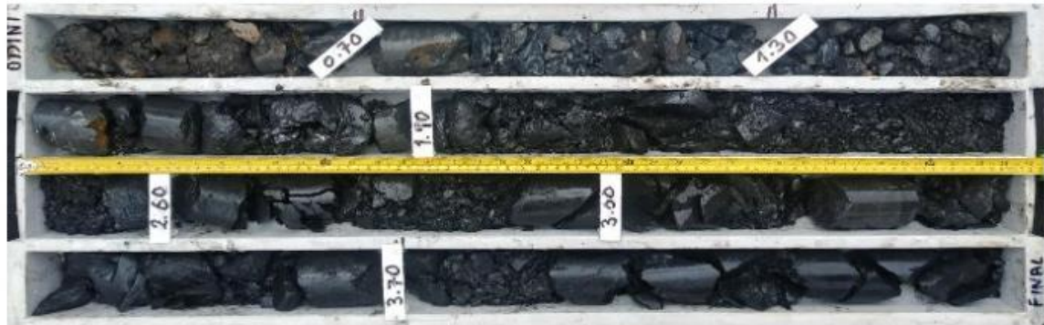
Fotografía 1: Caja 01/19: Profundidad de 0.00 – 4.30 m. Perforación: BH17-GA-09.
