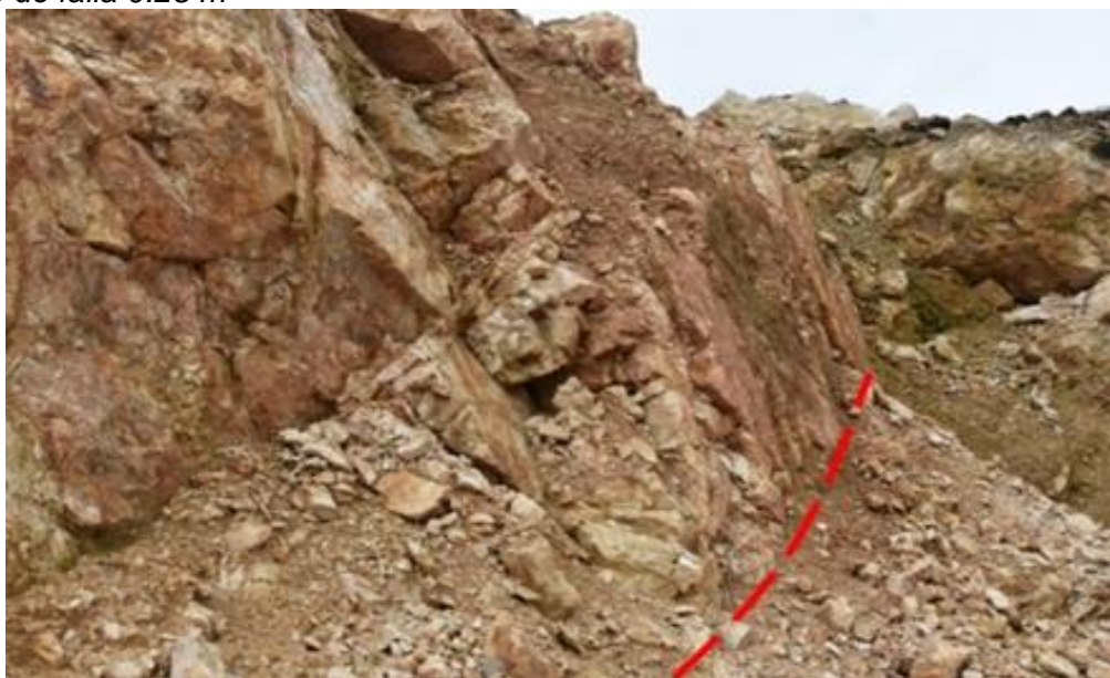
Vista al banco nv. 4084. Falla tectónica local (color rojo), rumbo E-O y buzamiento 65° S, ancho de falla 0.25 m
