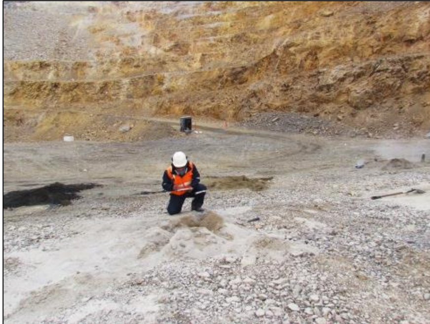
Logueo de blasthole
