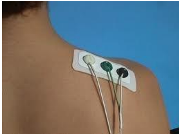
Figura 2.12. Electrodos EMG gelificado o húmedos. Fuente: Naik. (2012) Gelled or Wet EMG Electrodes
