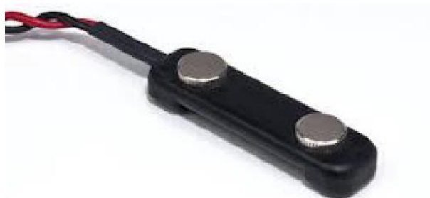
Figura 2.11. Electrodo EMG seco de Barra Reutilizable. Fuente: Naik. (2012) A Reusable Bar Dry EMG Electrode
