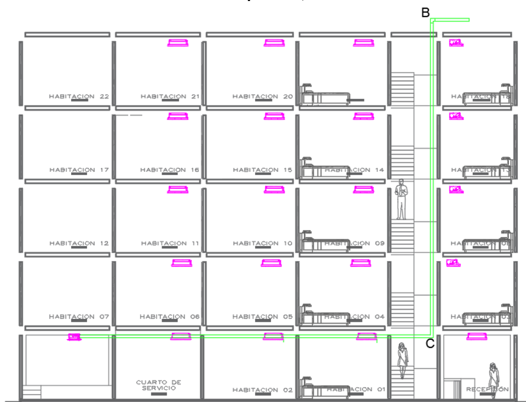
Figura 3.14. Recorrido de ducto seleccionado para el cálculo de caída de presión, en techo
