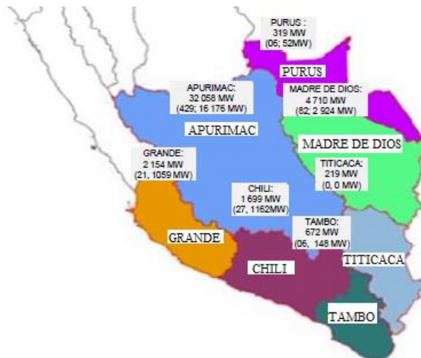
Figura 2.30. Mapa del potencial hidroeléctrico del sur del Perú. (MINEM, 2018b) Selección de 10 proyectos prioritarios con un total de 2 415 MW de capacidad instalada.
