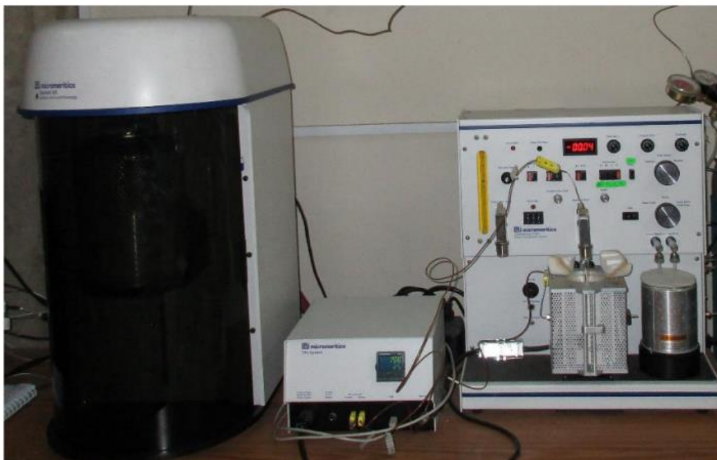
Figura 31: Equipo de TPO, Micromeritics ChemiSorb 2720. // Ubicado en el Laboratorio de investigación de Fisicoquímica – UNI.
