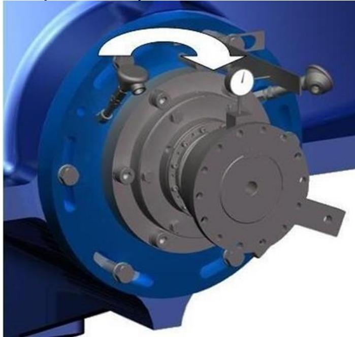
Para la instalación y extracción del ensamblaje del contra eje, gírelo 90 grados en el sentido de las agujas del reloj desde la posición de funcionamiento estándar. Esto hará que la flecha que apunta hacia arriba (en la posición de funcionamiento estándar) apunte hacia la derecha.
