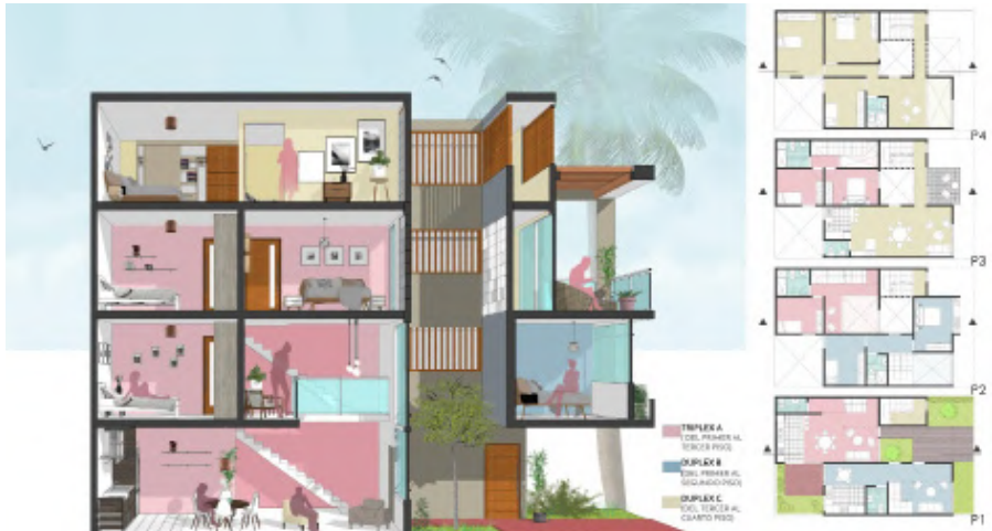
Corte transversal y planos de la vivienda tipo II. Por Cielo Bernahola.
