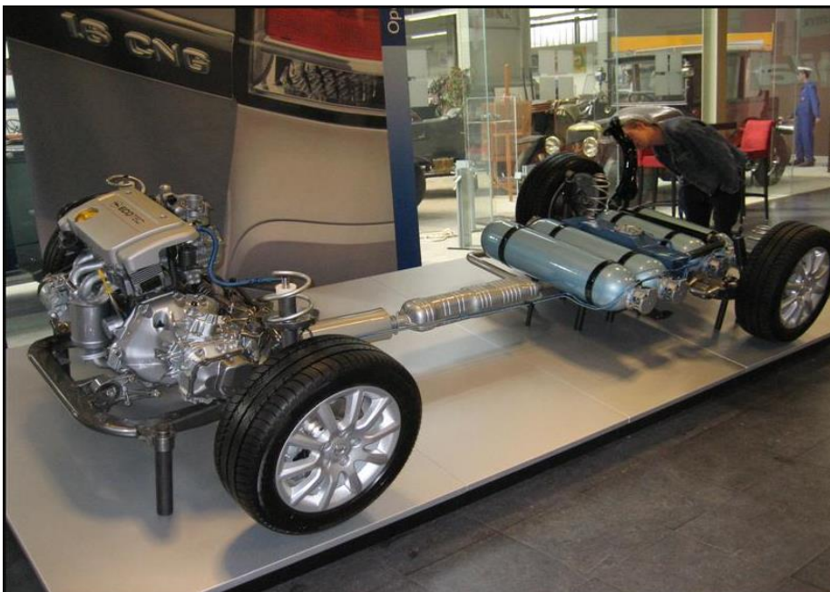
Figura 4 Componentes de un vehículo con motor GNV
