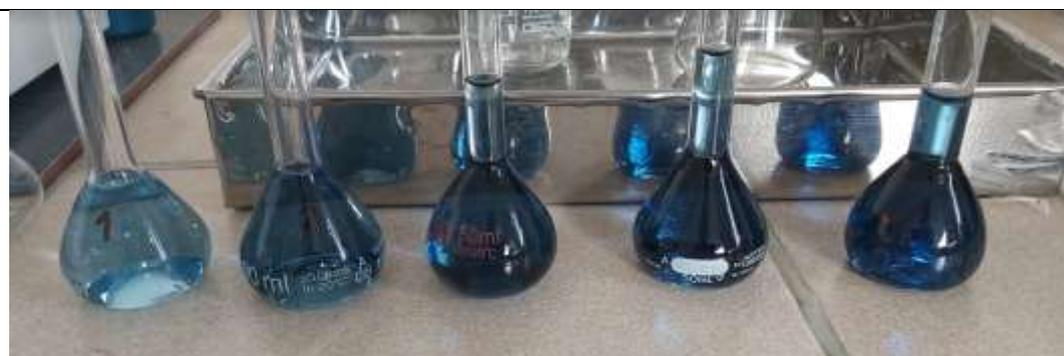
Una vez preparados los reactivos, se procede a mezclarlos en las diferentes fiolas (cada fiola contenía una cantidad de la muestra patrón distinta), con la finalidad de obtener la curva de calibración de fosfatos.
