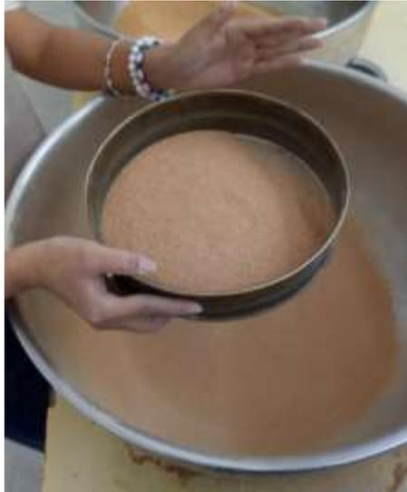
Para llevar la materia prima a carbonizar, se debe tamizarlo hasta obtener un tamaño de 0.5 mm. Para eso, se debe pasar las pepas por una molienda unas 3 a 4 veces hasta tener trozos lo suficientemente pequeños para poder ser tamizado al tamaño indicado.
