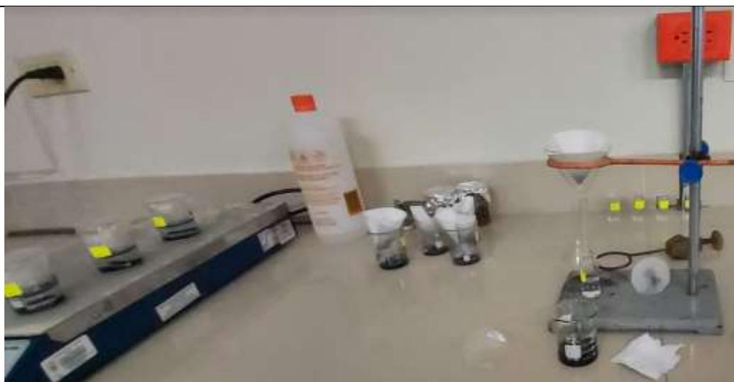
Una vez obtenido el pH de carga cero, se procedió a trabajar el procedimiento de adsorción en el pH que sea conveniente (en este caso, de neutro a ácido). Para esto, se colocó la misma cantidad de cada muestra de carbón en un medio con la misma concentración inicial de fosfatos. Estas fueron agitadas en un rango de tiempo de entre 0 a 48 horas. Finalmente, las preparaciones fueron filtradas y posteriormente se midieron las concentraciones finales de fosfatos de los distintos tiempo calculados.
