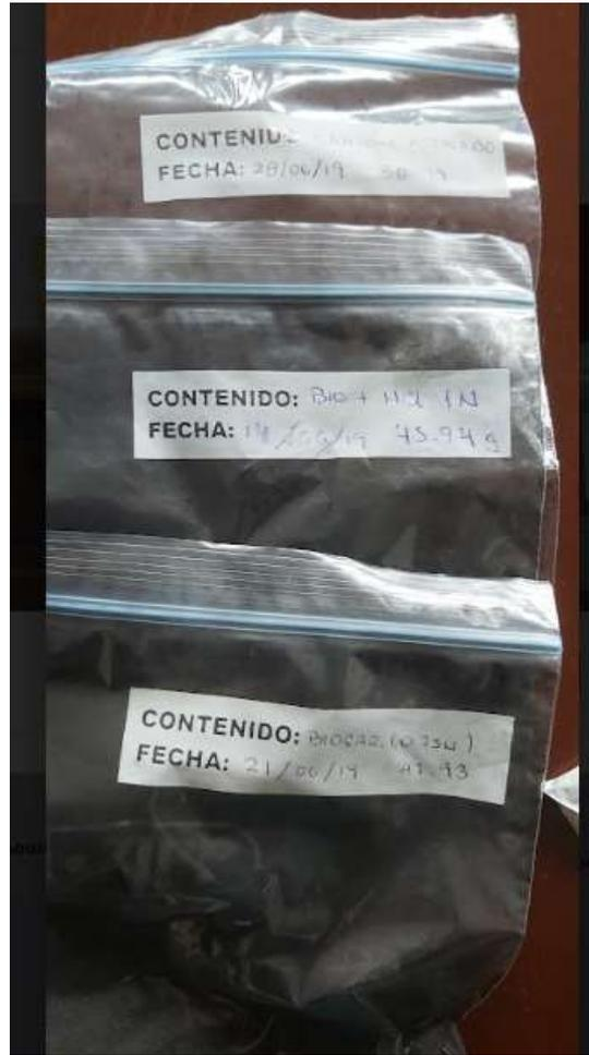
Finalmente, las tres muestras de carbón húmedas son llevadas al horno a unos 70°C por 24 horas para luego ser tamizadas y guardadas en una nueva bolsa ziploc debidamente rotulado.
