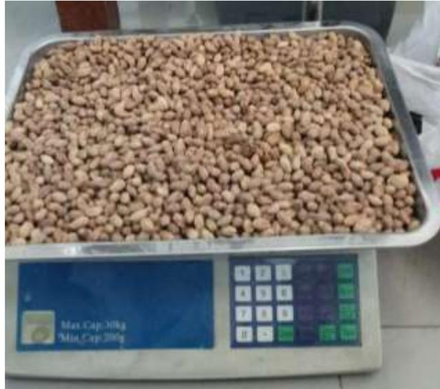
Se obtiene las pepas de los residuos de la fabricación de aceite de oliva, estas contienen restos de la carne de la aceituna; por lo que, se dejan remojar por 24 horas. Luego, se lijan con una malla de fierro para retirar dichos restos y se dejan secar a temperatura ambiente. Para eliminar la humedad, se llevan las pepas a un horno a 70°C por 24 horas.
