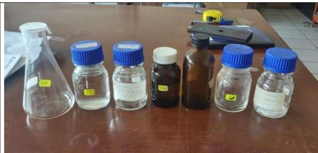
**Solución patrón de fosfato de 50 mg(P-PO<sub>4</sub>) /L:** Coloque 0.25 g de Fosfato diácido de potasio también denominado Fosfato monobásico de potasio KH<sub>2</sub>PO<sub>4</sub> grado analítico, a secar a 105°C durante dos (2) horas. Disuelva en agua ultra pura 0,2195 g de KH<sub>2</sub>PO<sub>4</sub> anhidro y diluya a 1000 mL en balón volumétrico. Almacene en la nevera a 4 °C en frasco de vidrio perfectamente rotulado. 1,00 mL = 50,0 µg PO<sub>4</sub><sup>3-</sup>- P.
