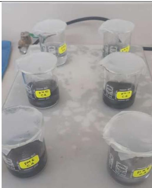
Para el procedimiento, el primer paso es obtener el pH de carga cero. Para este cálculo, se colaron muestras de carbón en medios con distintos pH. Estos fueron agitados por 120 min y se procedió a medir el pH final.
