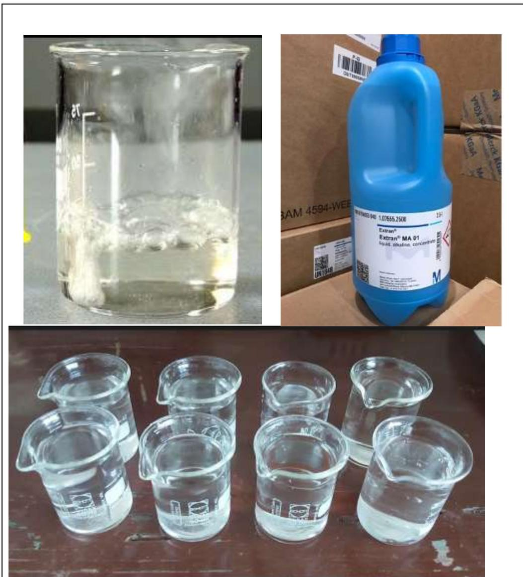
Para todos los instrumentos que fueron usados en el estudio (vaso de precipitado, pipetas, fioles, pastillas magnéticas, embudos, frascos de almacenaje), se debió lavar usando el procedimiento TP0125 Lavado Material de Vidrio.
