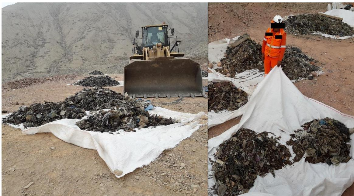
*Nota.* En primera instancia, se empleaba el cargador frontal dado el gran volumen y peso de las muestras. El cuarteo manual (uso de pala) era aplicado posteriormente a este paso.
