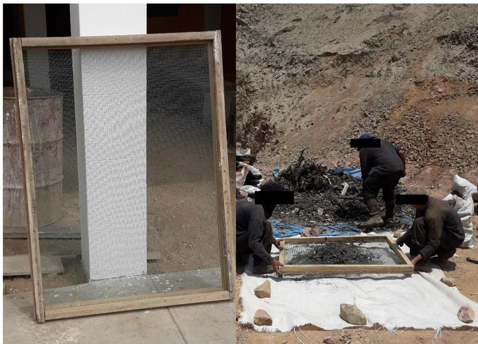
*Nota.* La figura muestra la malla de tamizaje (izquierda) y el tamizaje manual (derecha).
