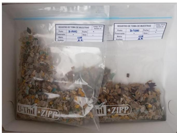
Nota. La figura muestra las muestras de fracción combustible de los puntos B y D.
