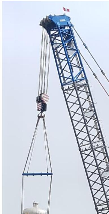
*Nota:* El separador de cargas añade estabilidad adicional a la carga ya que ordena los estrobos que pasan a través de él para levantar la carga.
