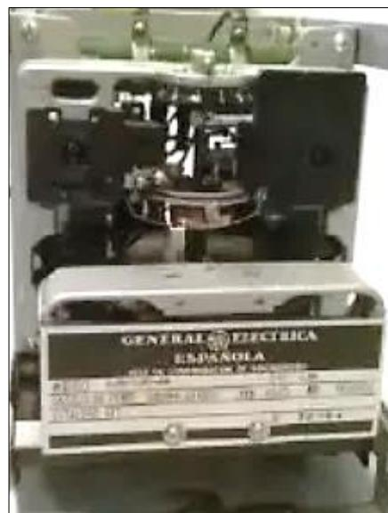
Fig. 23. Relé electromecánico
