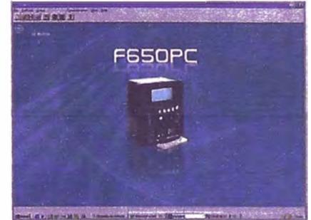
El programa de software gratuito EnerVista F650 Setup ofrece un acceso completo a la información del relé, así como a la configuración lógica de tipo PLC.
