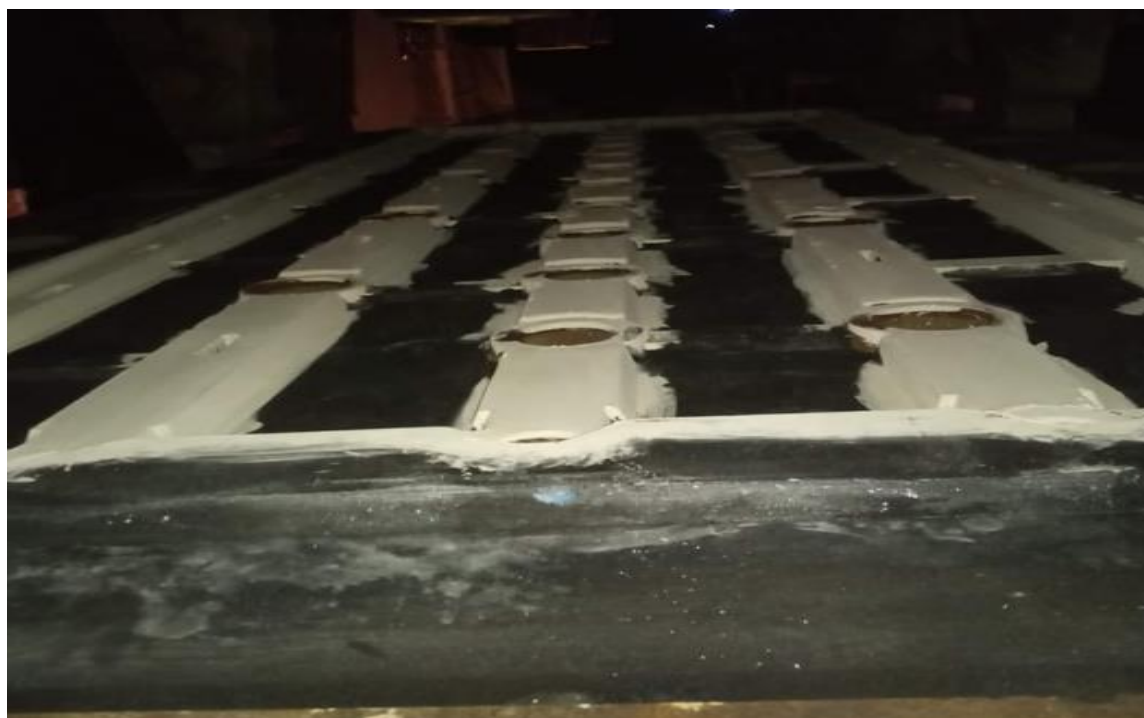
Anexo 8: Pintado molde tapa con pintura a base zirconio
