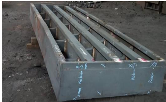
Figura 1: Pieza carro porta barrote, inicia con la limpieza de las zonas a aplicar líquido penetrante.
