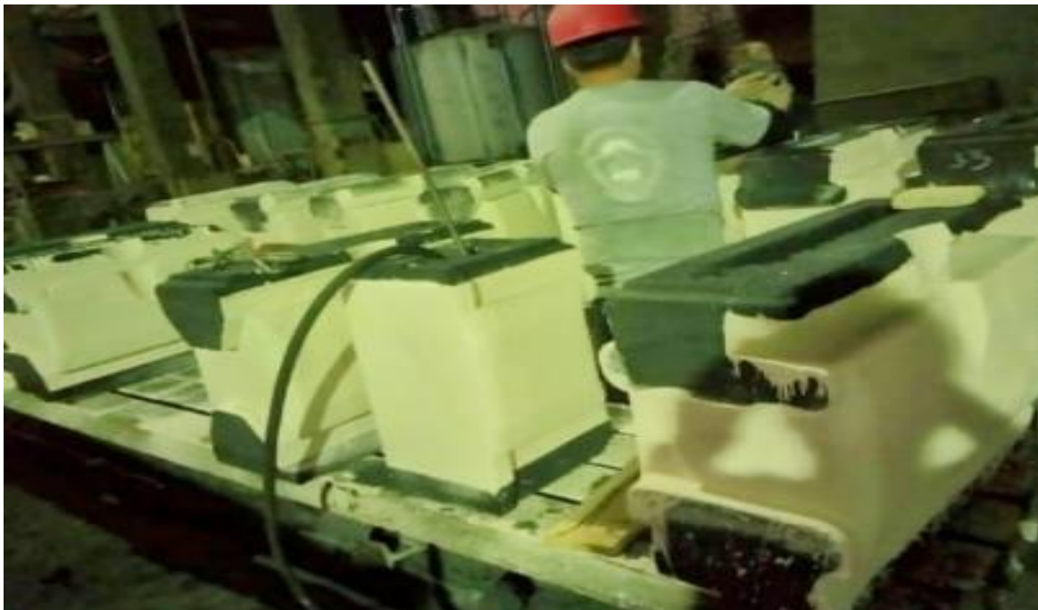
Anexo 7: Pintado de las almas con pintura a base zirconio
