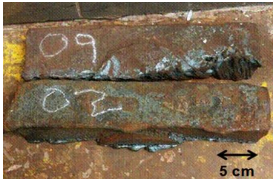
Figura 1: Muestra probeta de los carros porta barrote con tratamiento térmico
