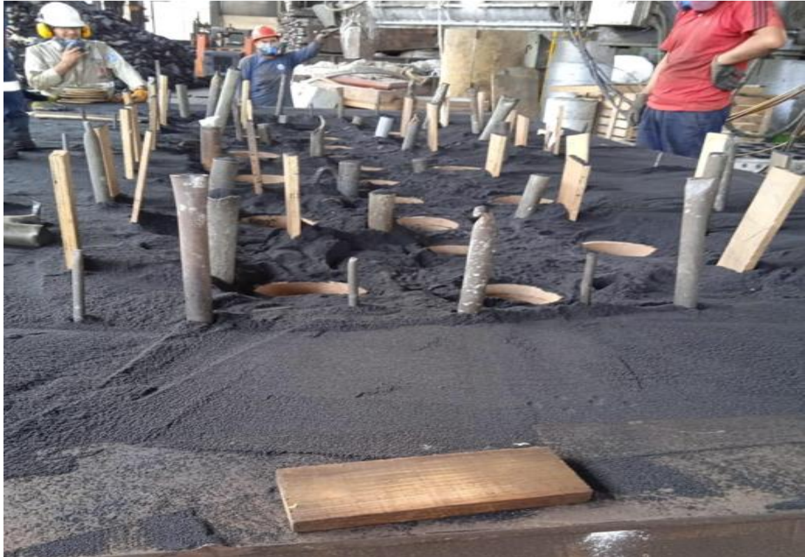
Anexo 5: llenado del molde con arena auto fraguado
