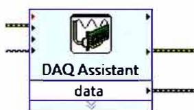
Figura 4.12. DAQ Assistant que permite la lectura de voltajes que son ingresados al socket del sensor de pH y al socket del sensor de temperatura. (fuente: captura de pantalla del diagrama bloques, elaborado por el autor)
