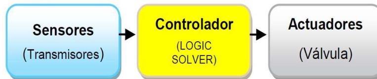
*Figura 3 - 17 Diagrama de bloques de un sistema SIS y BPCS.*
