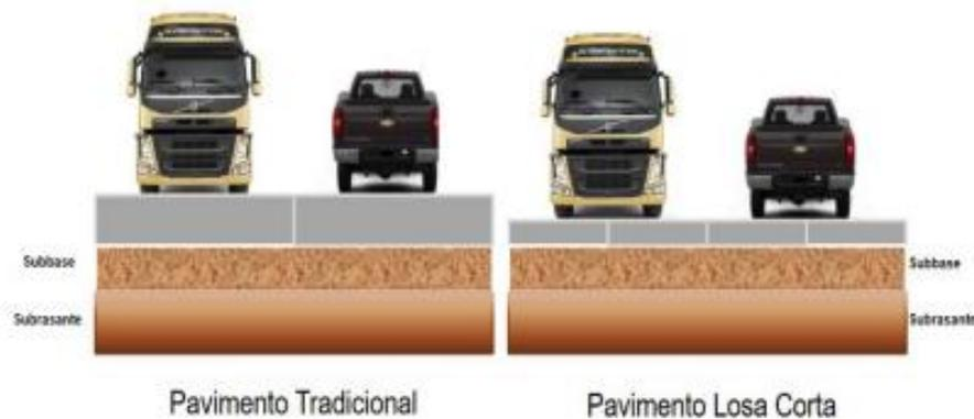
Gráfico N° 5: Pavimento tradicional vs Pavimento de losas cortas
