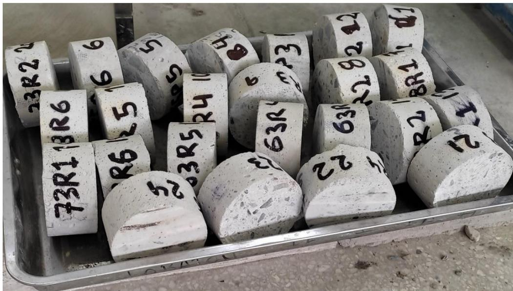
Figura A 61 Saturación de Muestras por Ebullición
