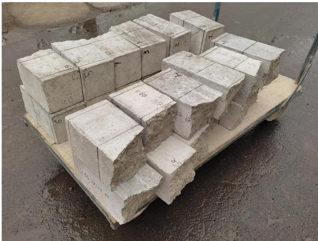
Figura A 60. Muestras de Concreto para Ensayo de Absorción, Densidad y Vacíos Permeables
