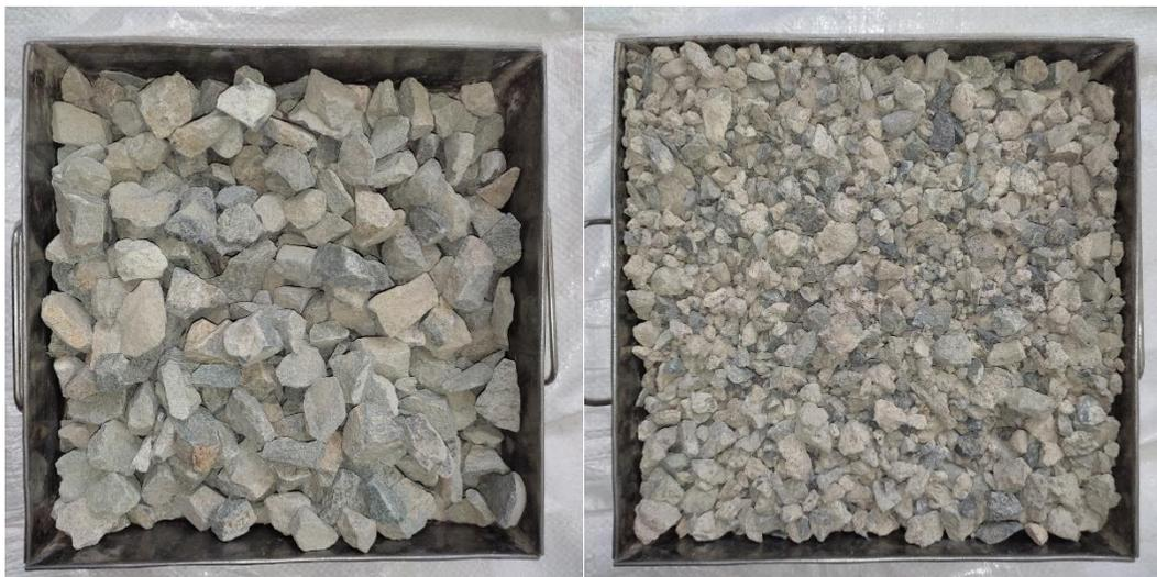
**Figura A 36.** Agregado Fino Natural (Izquierda) y Agregado Fino Ecológico (Derecha)
