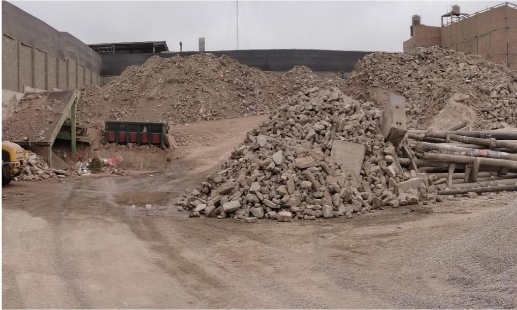
**Figura A 33.** *Salida Agregados Ecológicos del Equipo de Trituración*
