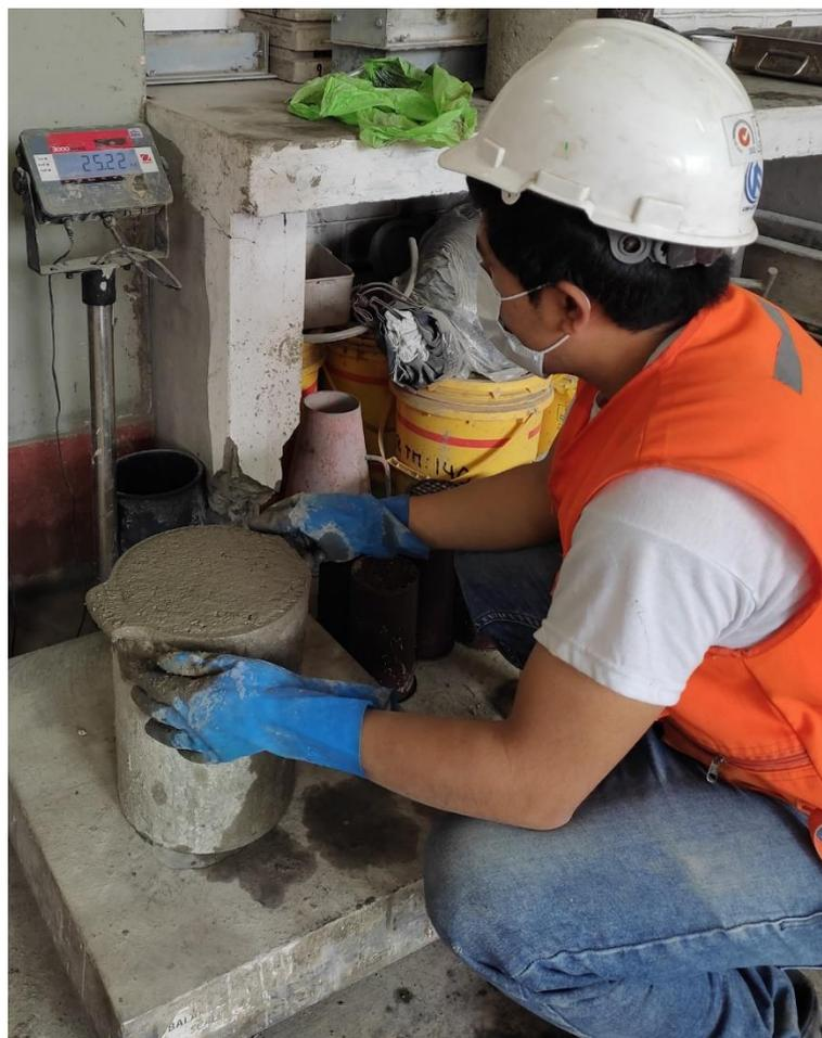
**Figura A 46.** Consistencia, Medición de Slump ce Concreto Fresco
