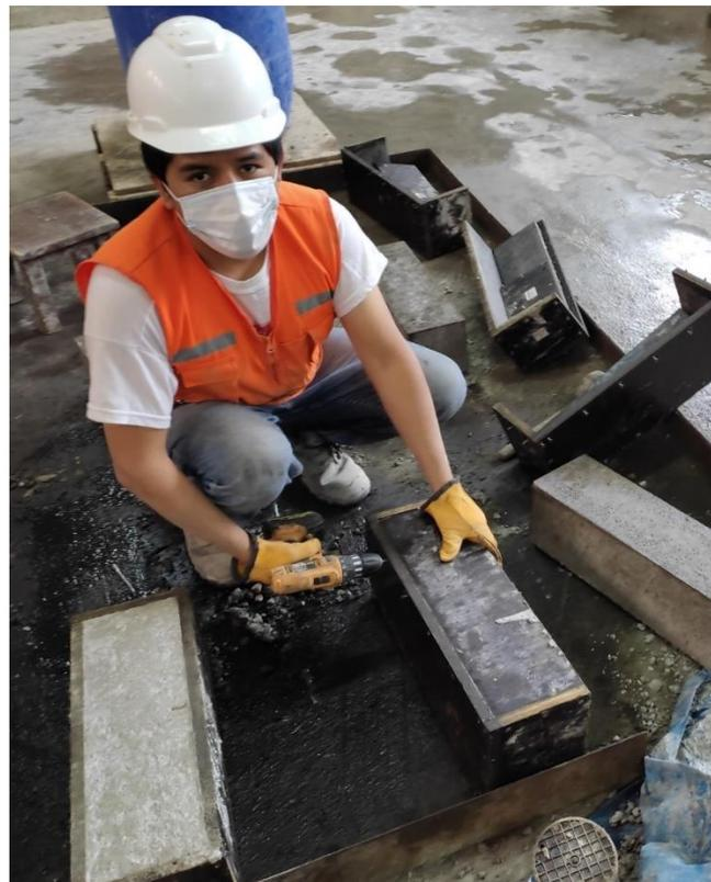
**Figura A 54.** Probetas y Vigas para Ensayos de Concreto Endurecido de un Diseño
