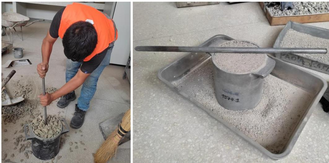
**Figura A 38.** *Peso Específico y Porcentaje de Absorción de Agregado Fino*
