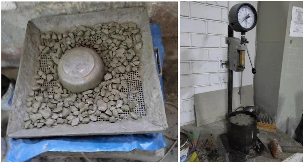
**Figura A 48.** Ensayo de Contenido de Aire en el Concreto Fresco
