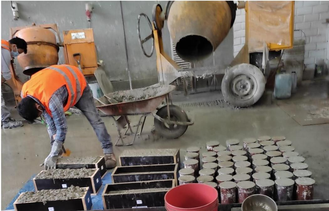
**Figura A 53. Desencofrado de Vigas para su Posterior Curado**
