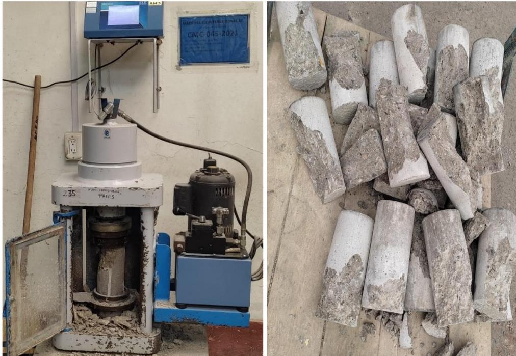
**Figura A 57. Ensayo a Tracción por Compresión Diametral**
