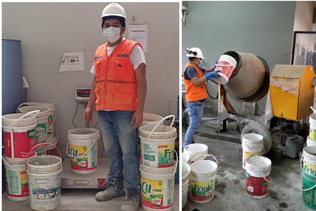
**Figura A 44.** Dosificación del Aditivo Superplastificante para el Concreto
