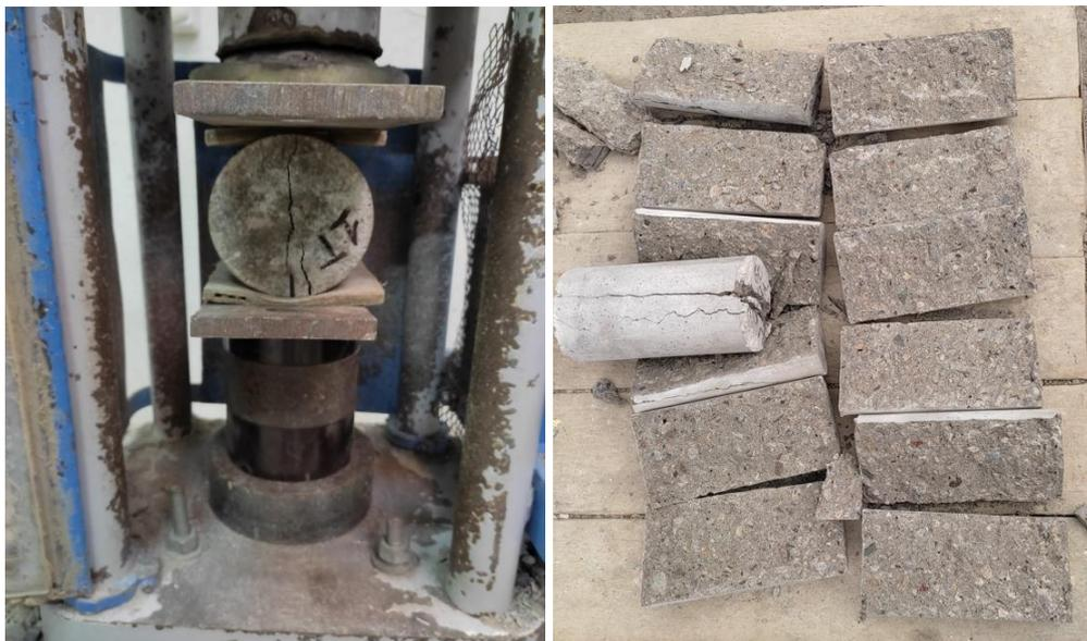
**Figura A 58** Ensayo a Flexión de Concreto Endurecido
