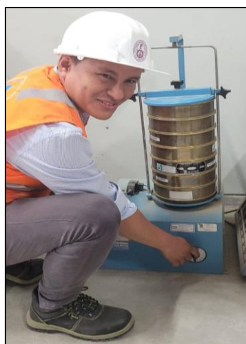
Figura 3 Equipo para el ensayo granulométrico de agregado fino.
