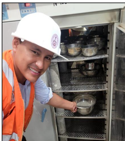
Figura 13 Ensayo de contenido de humedad de los agregados.
