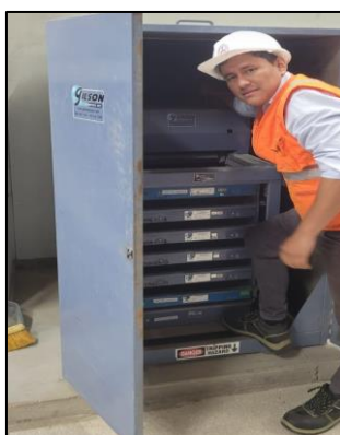
Figura 6 Equipo para el ensayo granulométrico de agregado grueso.
