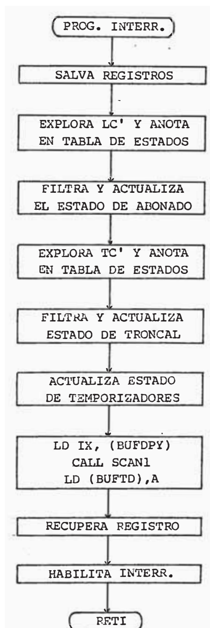
Figura 37. Diagrama de Flujo Programa Paralelo de Interrupciones
