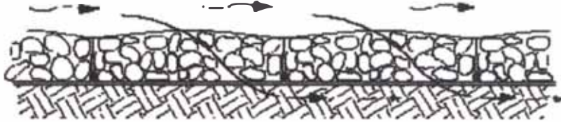
Fig. 3.2.2.g.: Flujo entre colchones y material base
